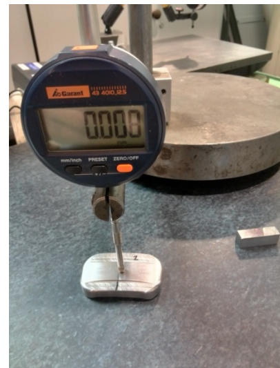
Obrázek 57-3 Měření výšky vahadel
