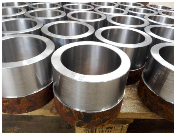
Obrázek 5.4 - Obrobený polotovár po prvním upnutí.
