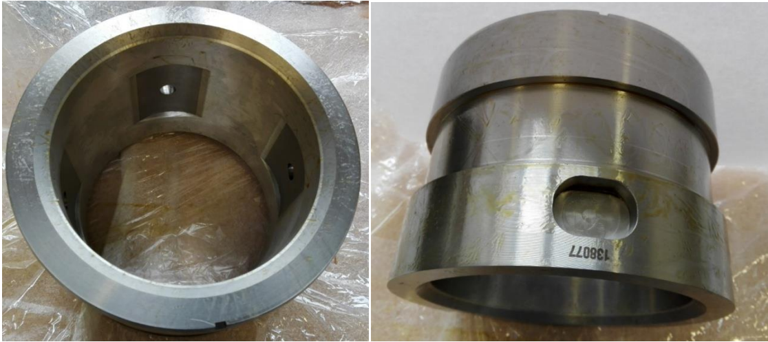
Obrázek 5.8 - Hotově obrobeneé a nakonzervované ložisko před zabalením.
