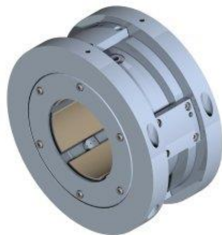
Obrázek 3.6 - Ložisko s radiálními segmenty-regulované.
