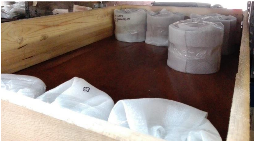
Obrázek 5.9 -Ukládání ložisek do přepravní bedny.
