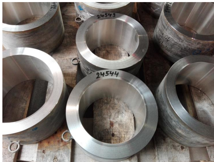
Obrázek 5.5 - Ložiska po obrobení pro ultrazvukovou kontrolu.
