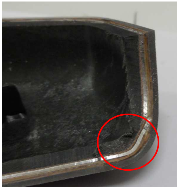
Obrázek 49 Tepelné poškození dýhy
