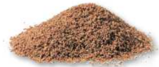
Obrázek 22 Technické činidlo ze skořápek vlašských ořechů
