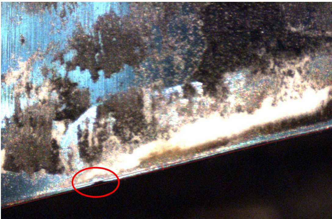
Obrázek 53 Opotřebení nástroje – varianta 2 (120x zvětšeno)
