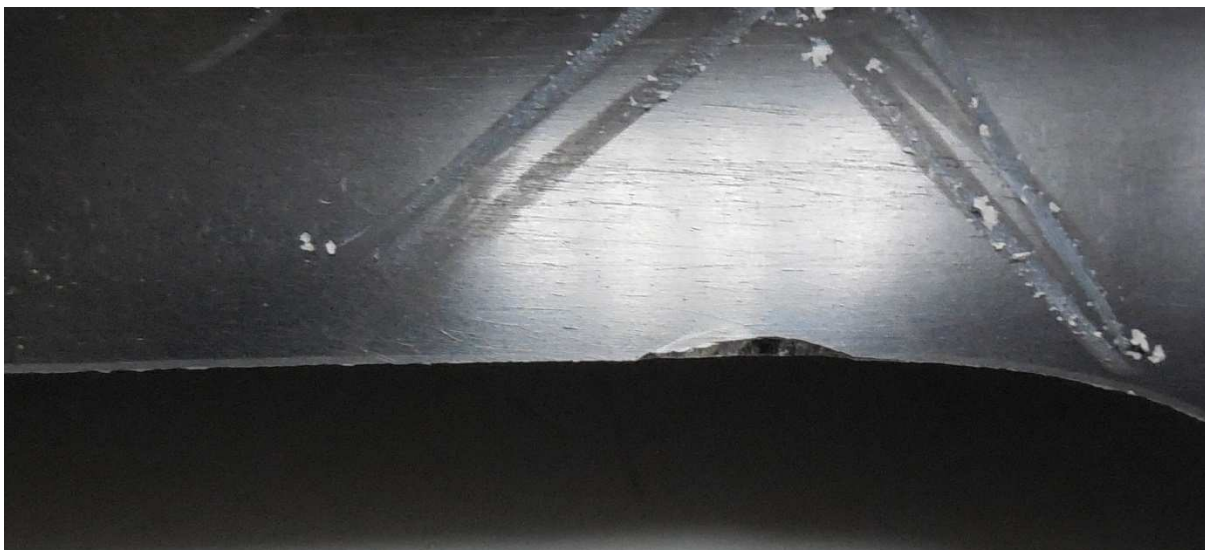
Obrázek 11 Ukázka odštípnutí laku
