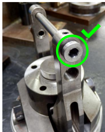
Obrázek 7-26: Původní (vlevo) a nový (vpravo) aretační šroub [vlastní zpracování]
