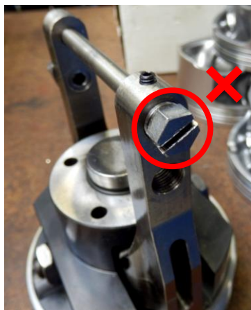
Obrázek 7-26: Původní (vlevo) a nový (vpravo) aretační šroub [vlastní zpracování]
