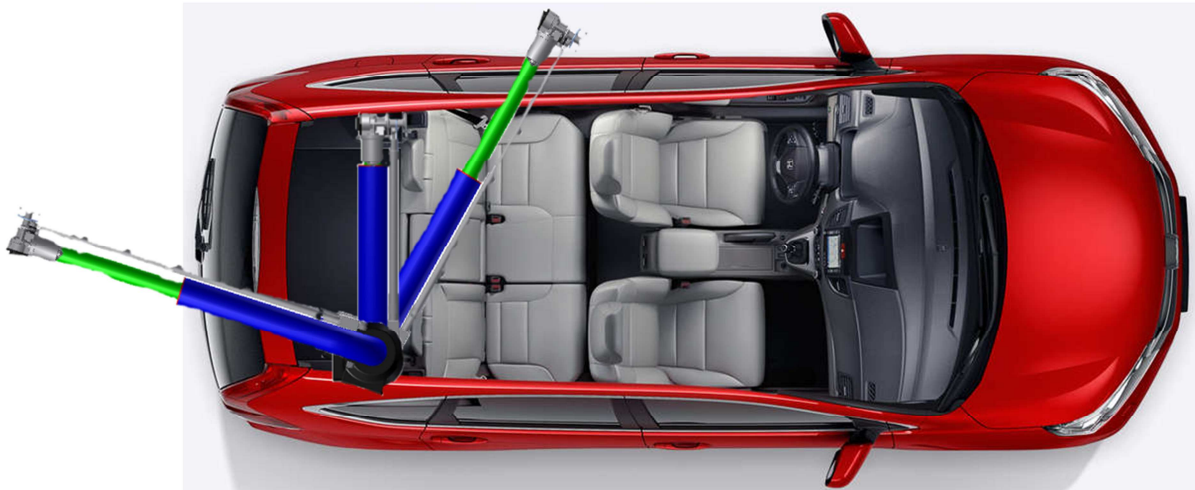
Obr. 63 – Umístění a funkce jeřábu ve vozidle (16)
