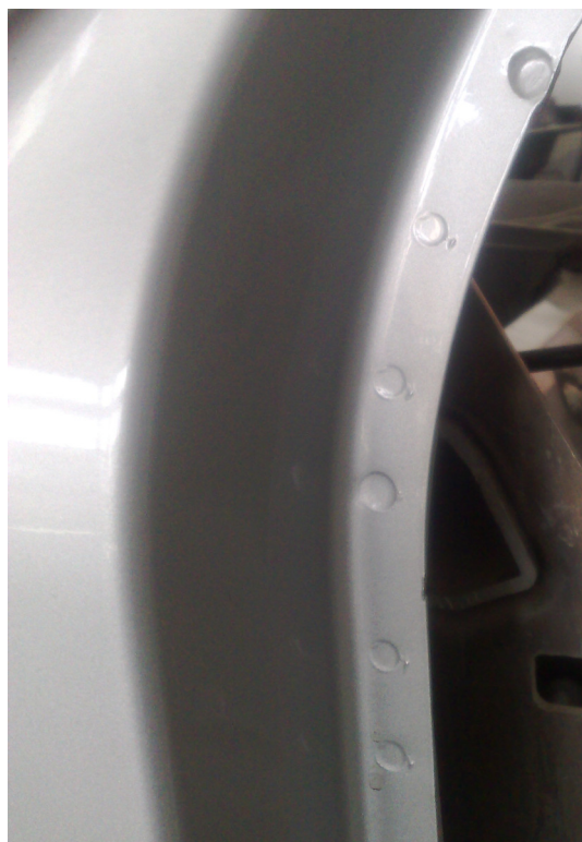
obr. 52: provedení svarů na dosedací ploše dveří v oblasti napojení A-sloupku na spodní část karoserie
