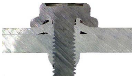
obr. 36: Flow Drill šroub v řezu [49]
