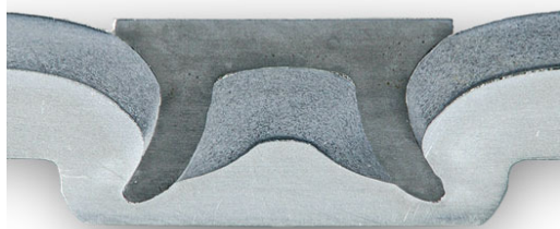
obr. 68: spojení ocelového a hliníkového plechu samořezným nýtem v řezu [59]
