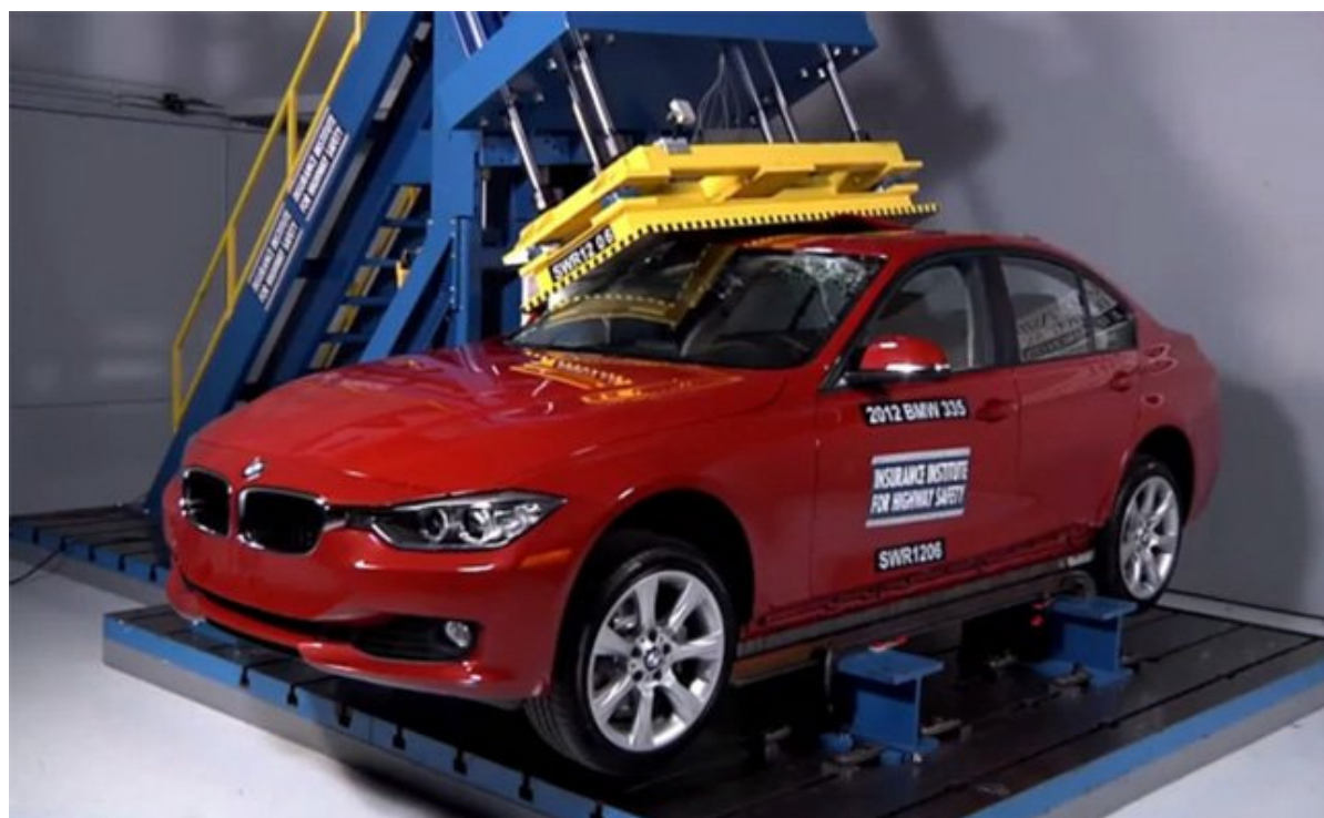
obr. 9: stlačování vozidla na zkušebním standu během zkoušky [9]
