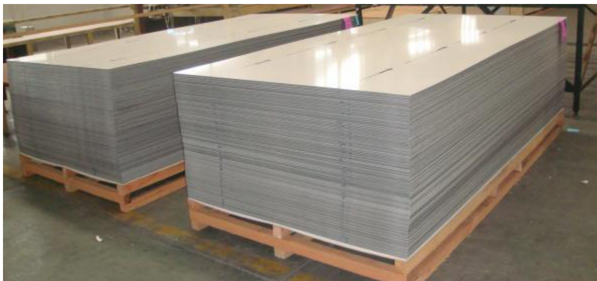
obr. 66: napaletovaný materiál EN AW-6061 připravený ke zpracování [54]
