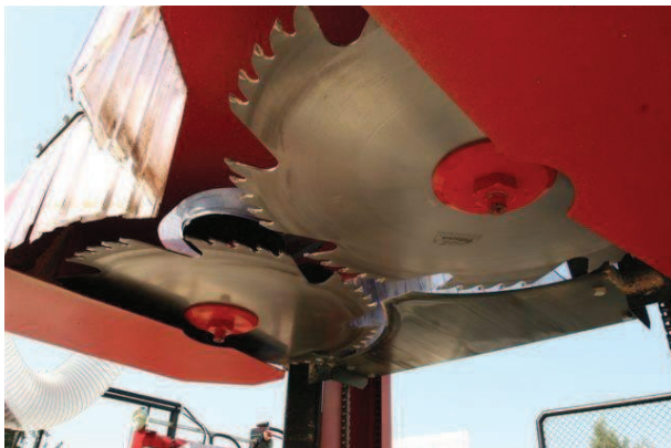
Obrázek 7: Dvouhřídelová pila s vertikální osou [15]
