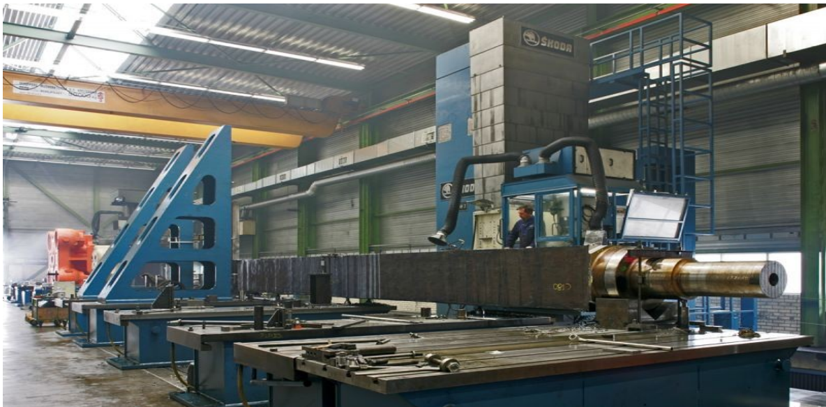
Obr 1.2 : Vyrtávačka HCW-2-holland [ŠKODA MACHINE TOOL 10/ 2015 ]
