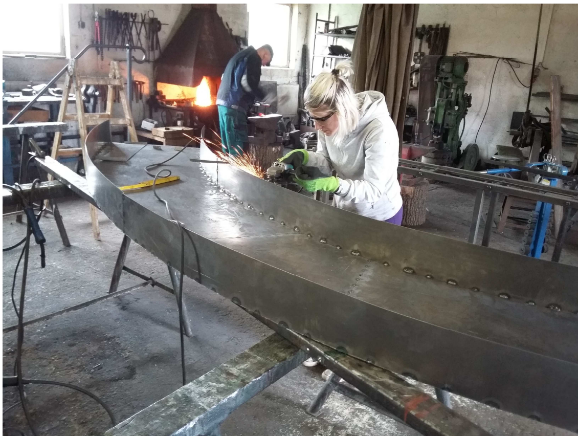
Úprava kovového segmentu
