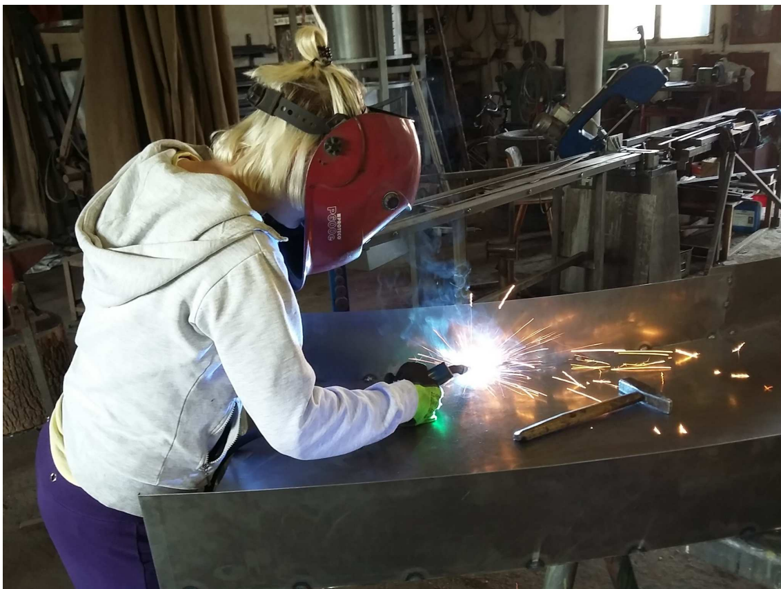
Svařování kovového segmentu
