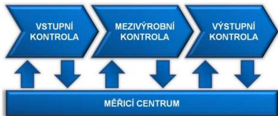
Obr. 3.6 Průběh kontroly kvality v EBC.
