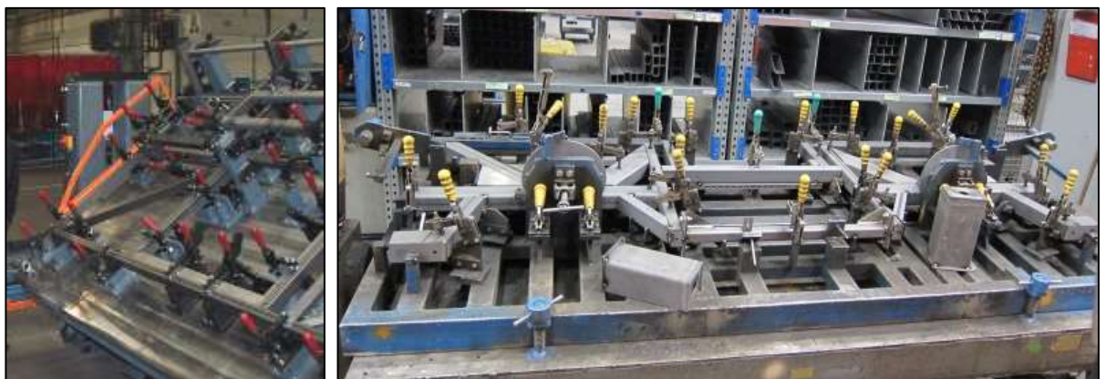
Obr. 3.9 Příklady svařovacích přípravků pro jednotlivé nosníky segmentu. [9]
