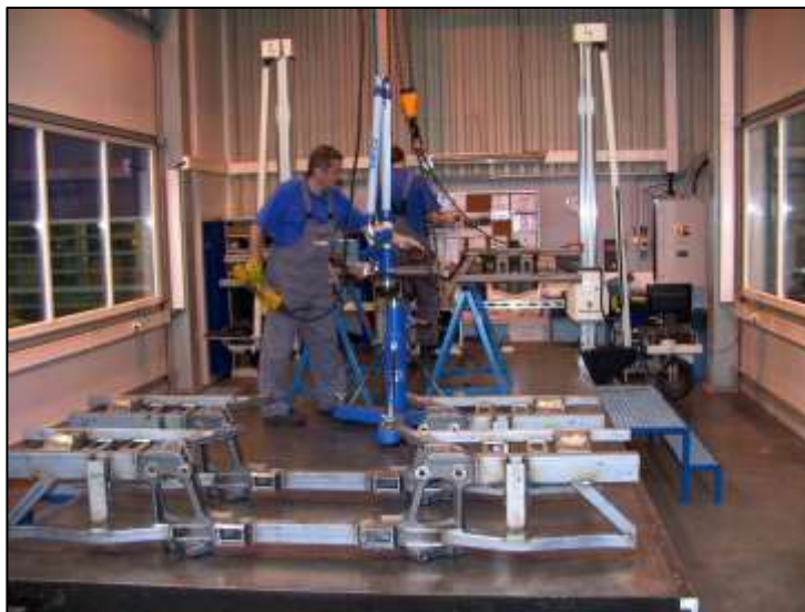
Obr. 3.14 Měřicí centrum v EBC a měřicí rameno FARO. [9], [11]
