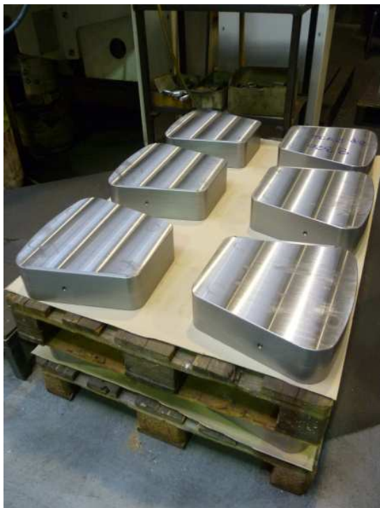
Obr. 1.2 – Segmenty pro axiální ložiska
