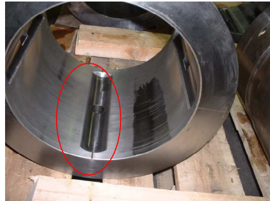
Obr. 1.5 – Poškozené kluzné ložisko
