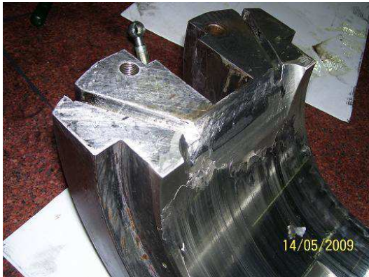
Obr. 1.4 – Poškozené kluzné ložisko
