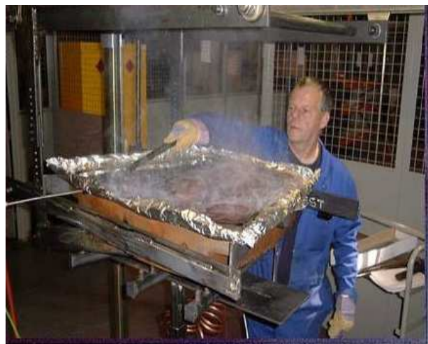
Obr. 2.2: Metoda statického lití [8]
