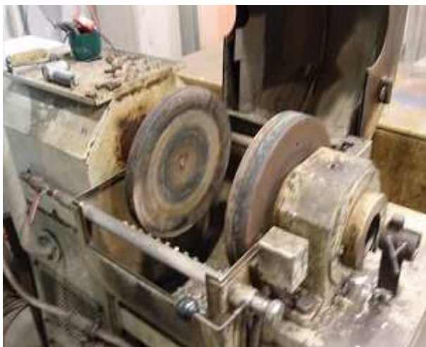
Obr. 2.1: Stroj na odstředivé lití [4]
