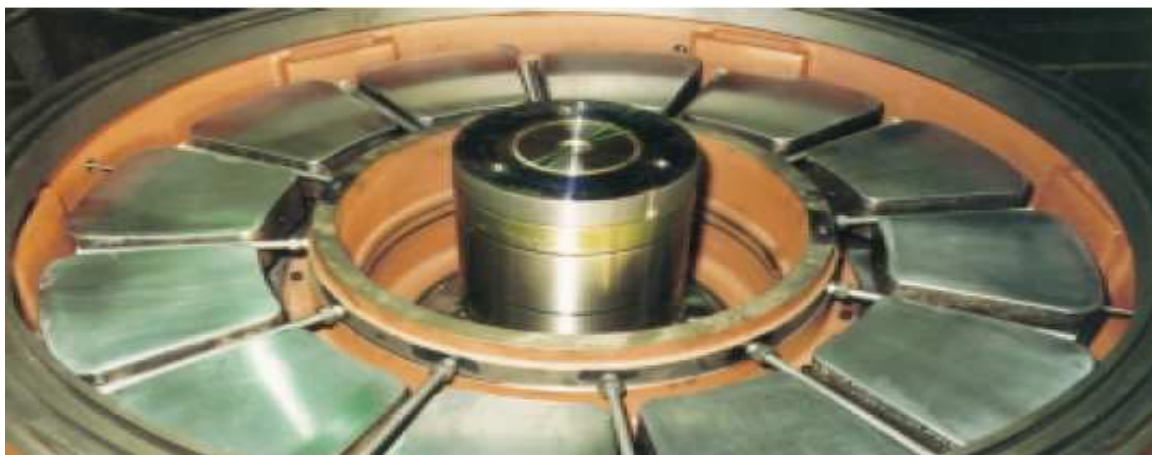
Obr. 2.8: Segmenty kluzného ložiska s cínovou výstelkou v planetové převodovce, hydrodynamicky mazané [2]
