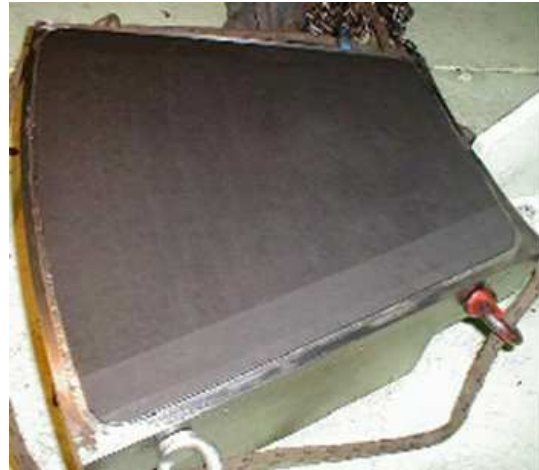
Obr. 3.8: Opatřovaná kluzná vrstva na bázi cínu [8] Obr. 3.9: PTFE segment po 1500 hodinách provozu ve stejném stroji [8]
