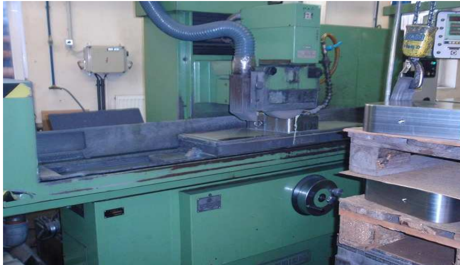
Obr. 2.5: Broušení kluzného segmentu [4]
