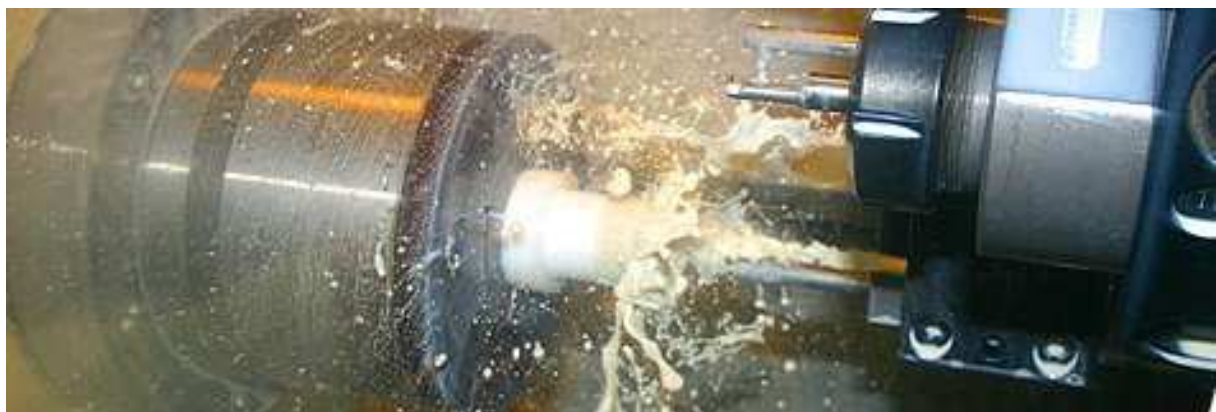
Obr. 3.12: Obrábění čistého teflonu[3]
