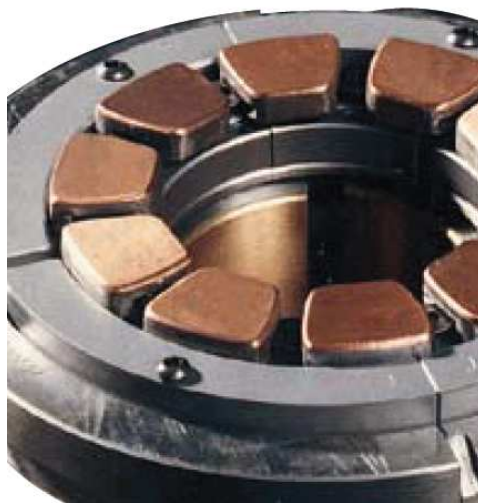
Obr. 4.1: Kluzné segmenty s měděnou výstelkou [19]
