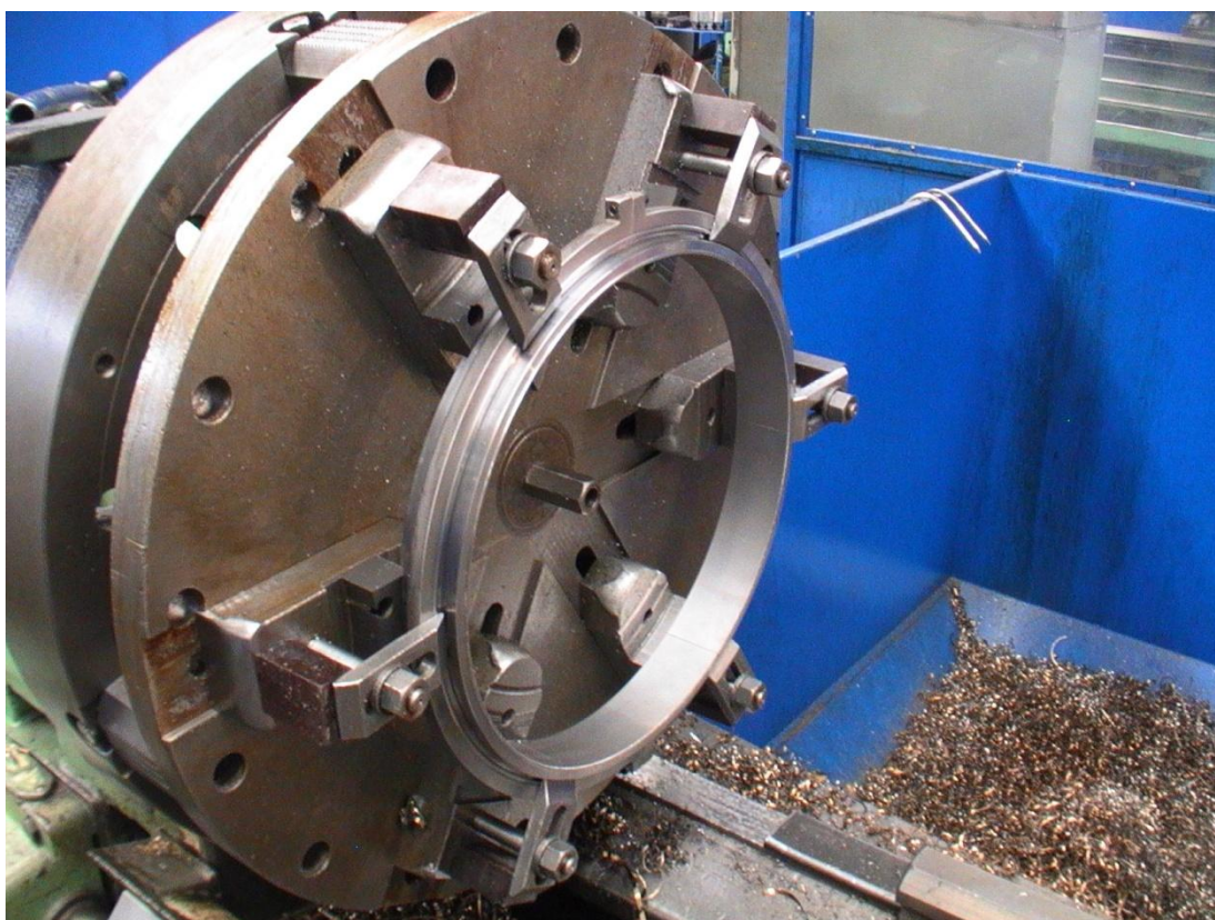
Obr. 2.9 - Upnutí při operaci dokončování
