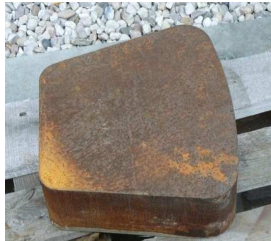
Obrázek 1-2 – Polotovary radiálního ložiska [12] Obrázek 1-3 -Polotovary pro axiální ložiskový segment [12]
