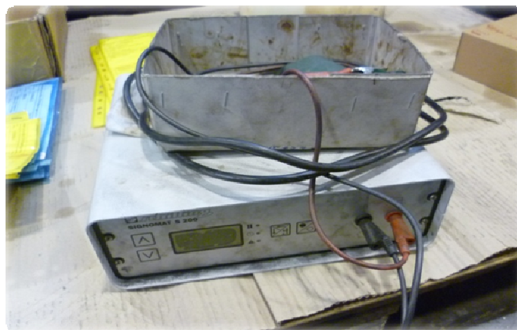
Obrázek 3-12 - Souprava na popis nástrojů a ložisek pomocí leptání [12]
