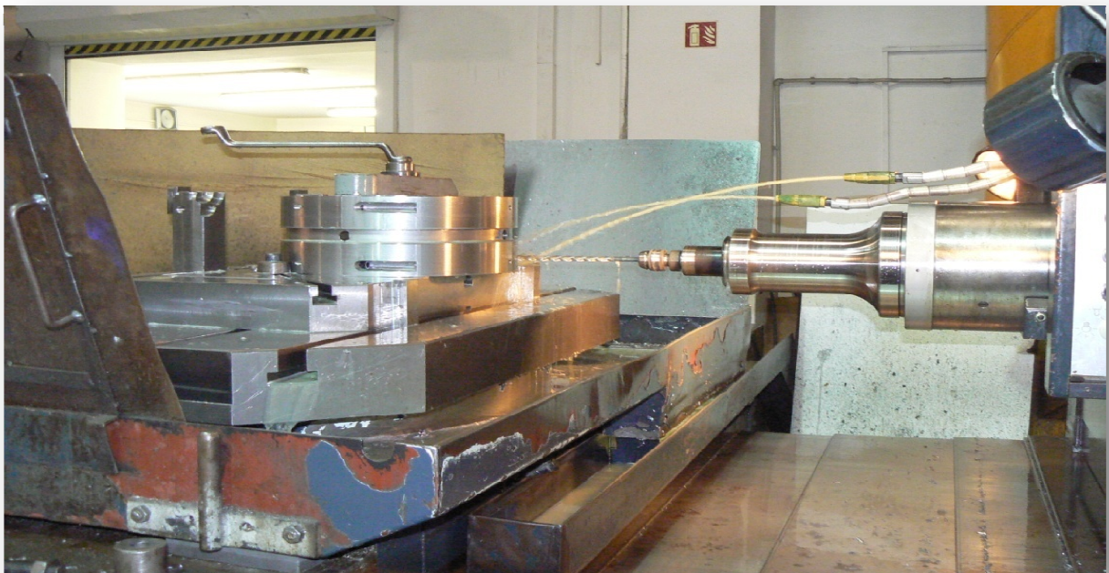
Obrázek 1-5 - Výroba mazacích otvorů [12]
