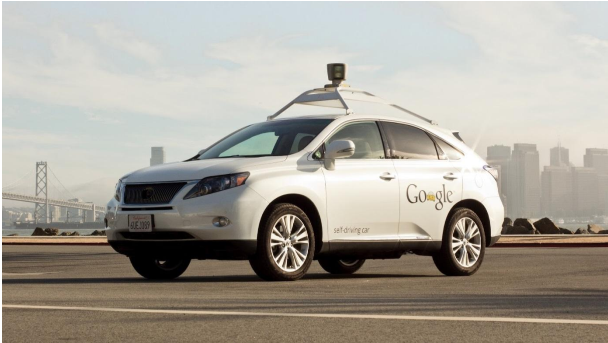
Obrázek 7 Google-auto s připevněným otočným lidarem na střeše [28]
