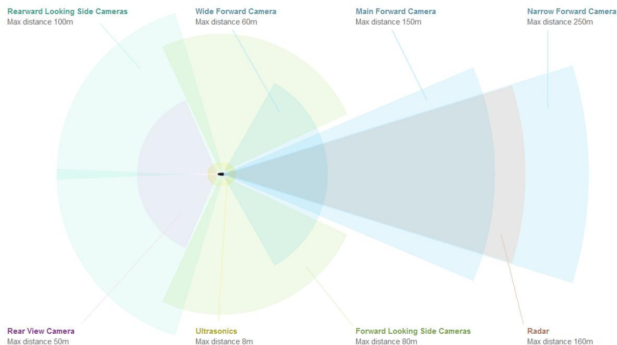
Obrázek 8 Pokrytí okolního prostředí pomocí senzorů na vozidle Tesla [4]
