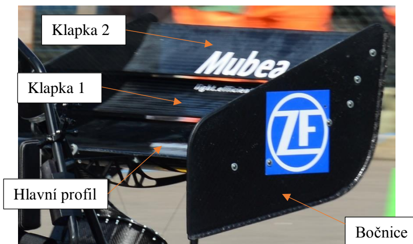
Obr. 5 Víceprvkové křídlo vozu UWB03
