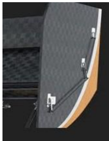
Obr. 12 Mechanismus vně bočnice se dvěma servy po stranách od Team Delft
