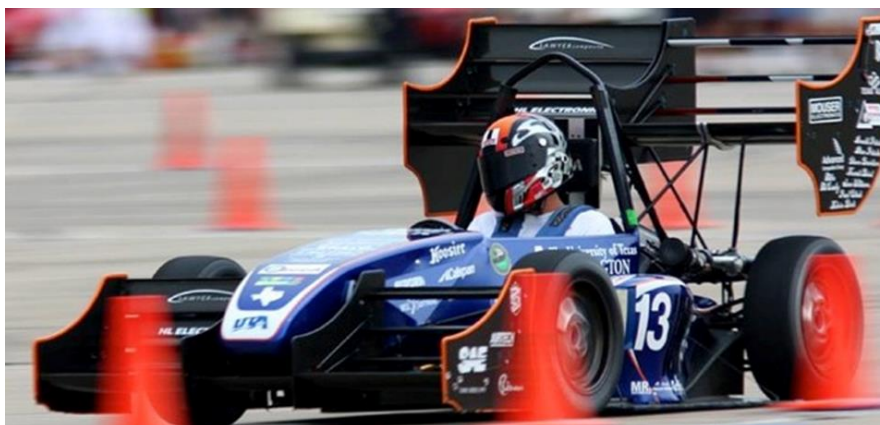
Obr. 13 Vůz UTA Racing se čtyřmi individuálně ovládanými kvadranty aktivní aerodynamiky
