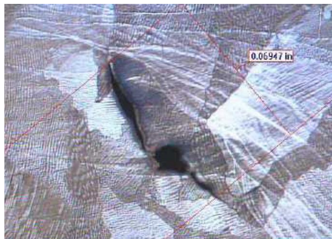
Obr. č. 20 - Horká trhlina v Inconelu 52 [11]
