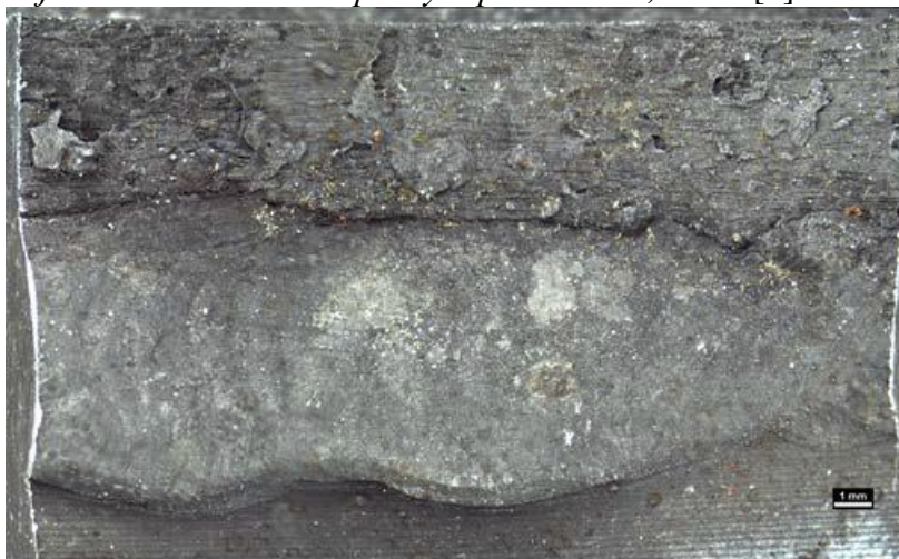
Obr. č. 48 - Korozní poškození (důlky) na povrchu 22K
