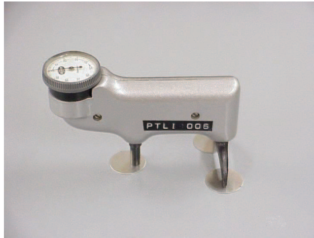
Obrázek 15: Přístroj pro měření tvrdosti Barcol [21]
