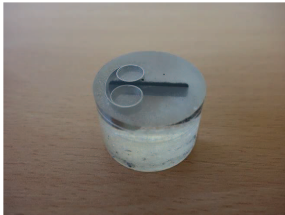
Obrázek 30: Výbrus vzorku v epoxidové pryskyřici
