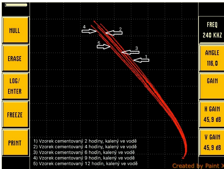
Obrázek 28. - Měření – vzorek cementovaný, kalený ve vodě BRIDGE
