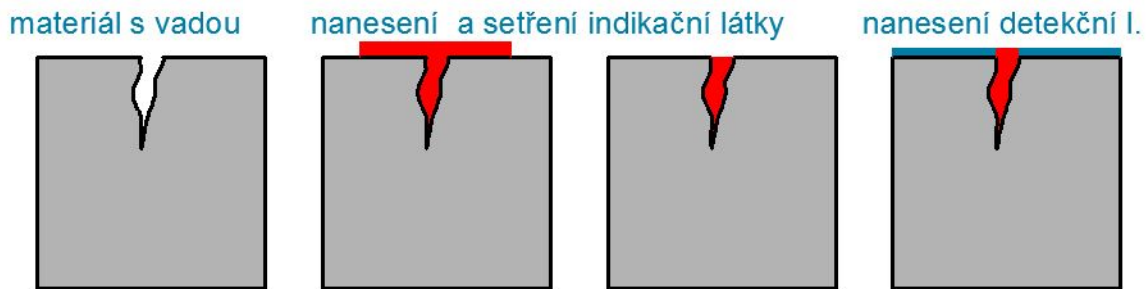
Obrázek 1. - Schéma kapilární zkoušky. [20]
