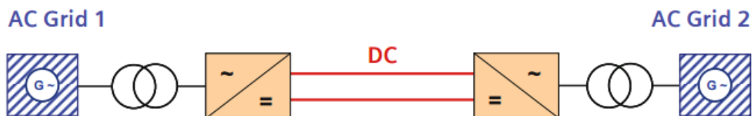
Obrázek 4.3: Princip technologie HVDC [38]
