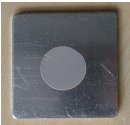
Obr. 4.2 Substrát 2. typu s nanesenou dielektrickou vrstvou
