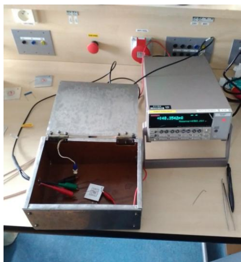
Obr. 4.9 Elektrometr KEITHLEY 6517A s otevřeným stínícím boxem
