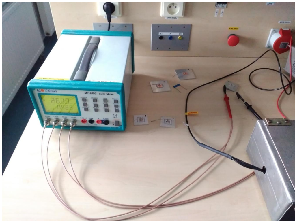
Obr. 6 Měřicí přístroj RLC metr MOTECH MT 4090
