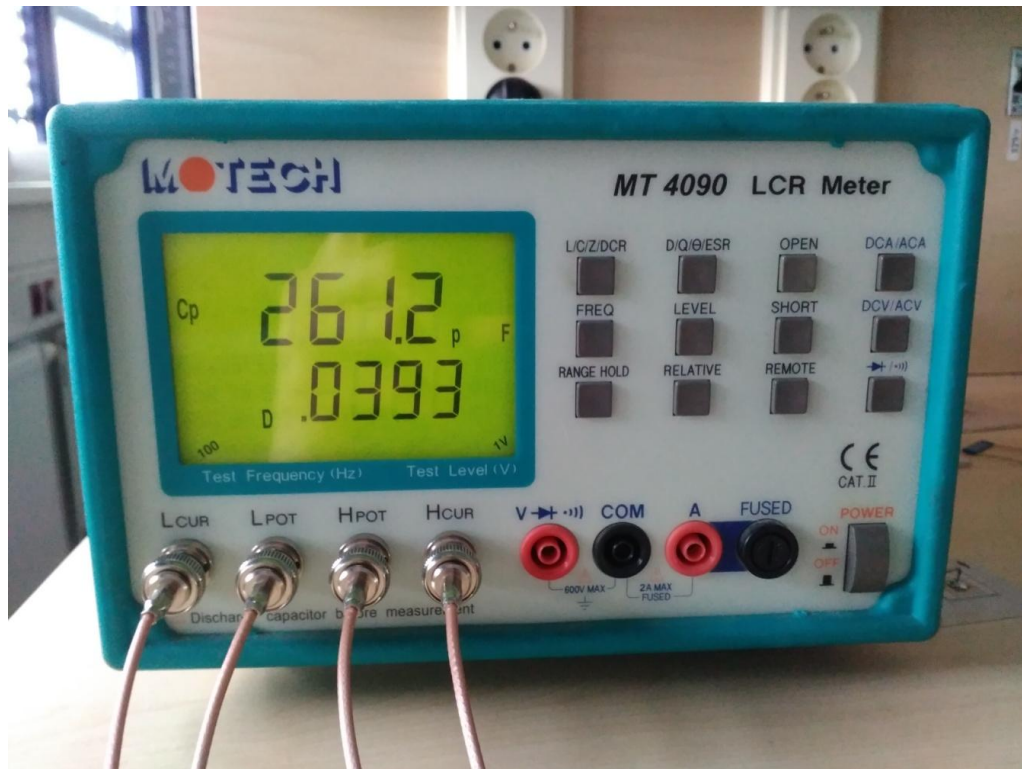
Obr. 7 Detail displeje měřicího přístroje RLC metr MOTECHE MT 4090
