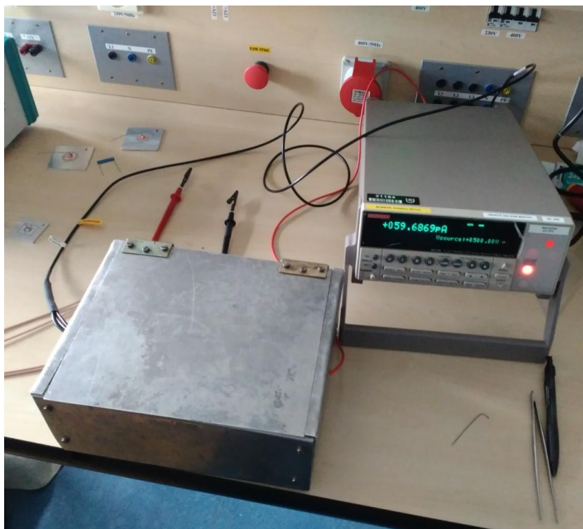
Obr. 9 Elektrometr KEITHLEY 6517A se zavřeným stínícím boxem
