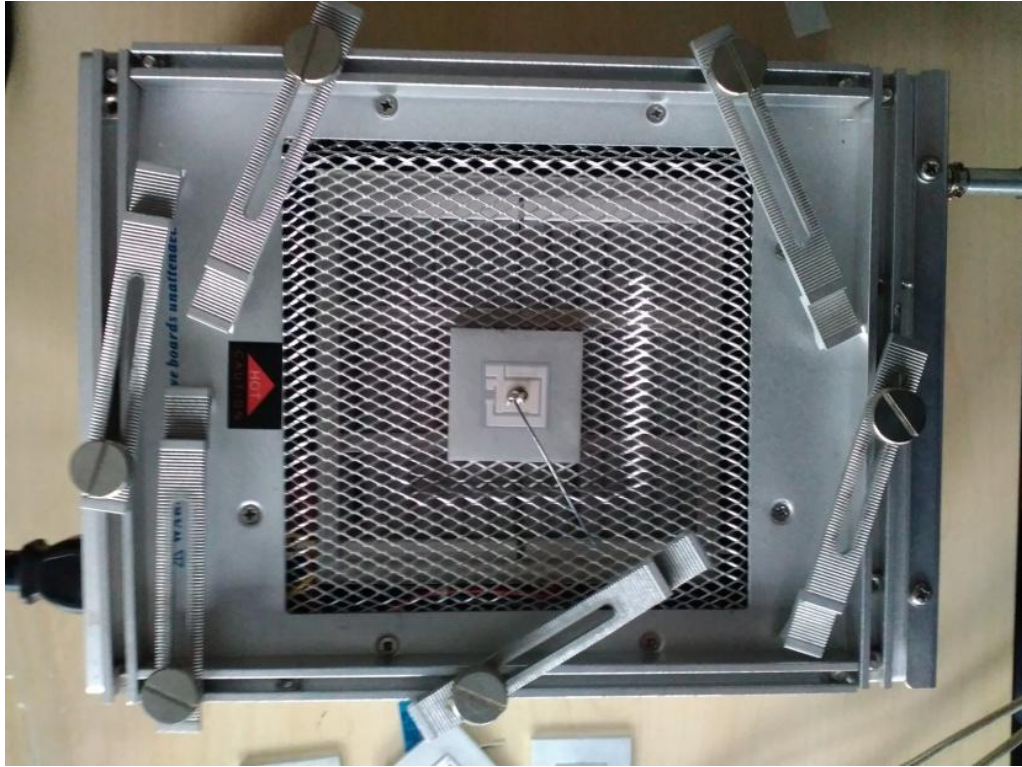
Obr. 5 Substrát 1. typu umístěný na plotýnce, která prohřívala substrát a usnadňovala pájení vývodu
