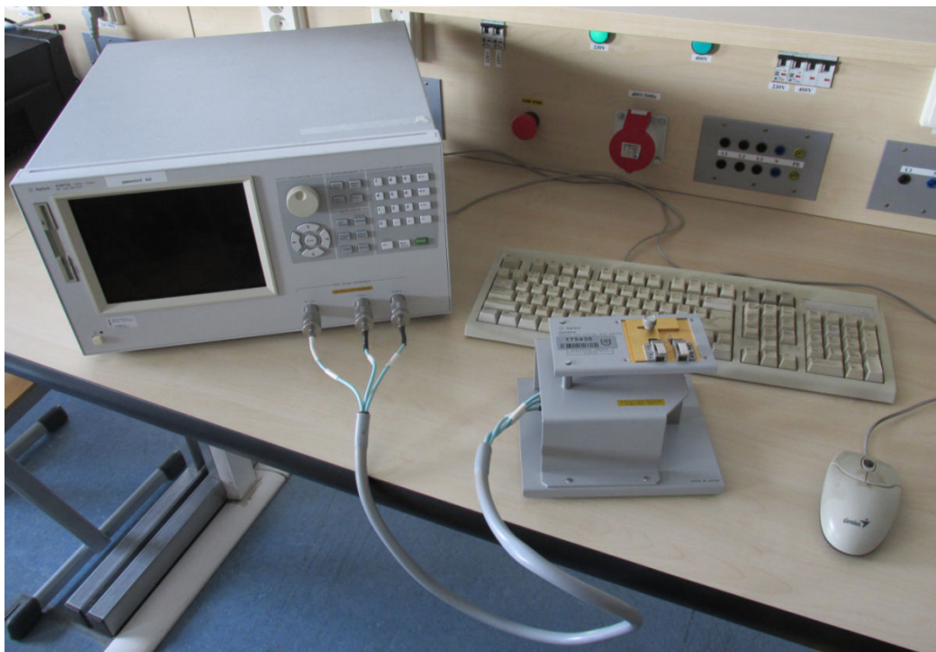
Obr. 3.4 Testování vzorků – Agilent 4287A RF
