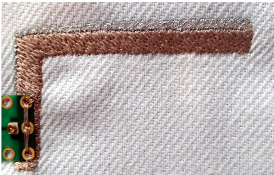
Obr. 6.1: Detail špatného sesazení sítotisku a všívání
