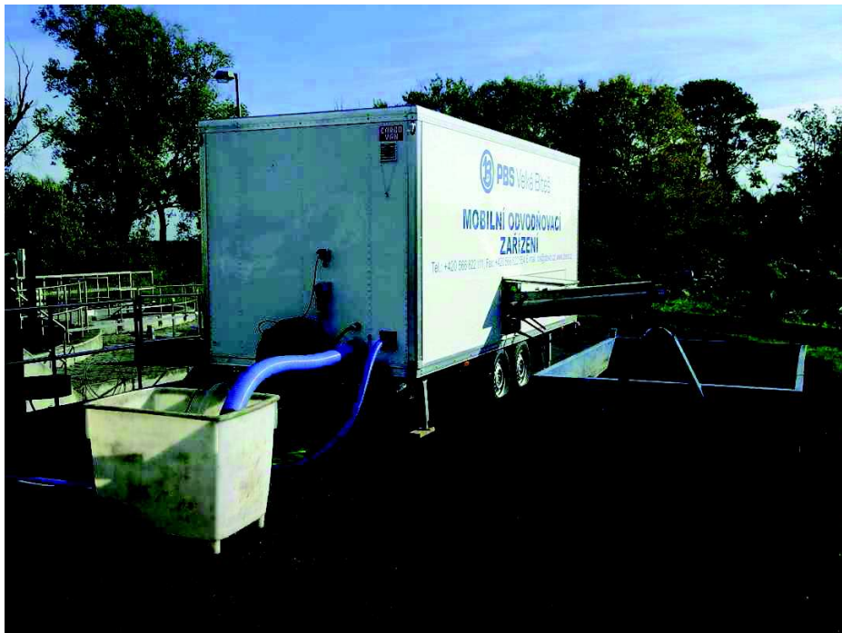
Obrázek č. 52 – Rozestavení mobilní odstředivky na staveništi
