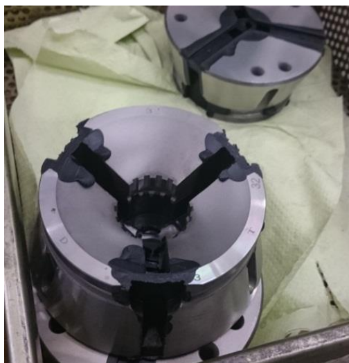
Obrázek 32 Odstranění vulkanizovaného přebytku
