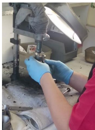
Obrázek 33 Odstranění přebytků vulkanizovaného kaučuku pomocí kartáče
