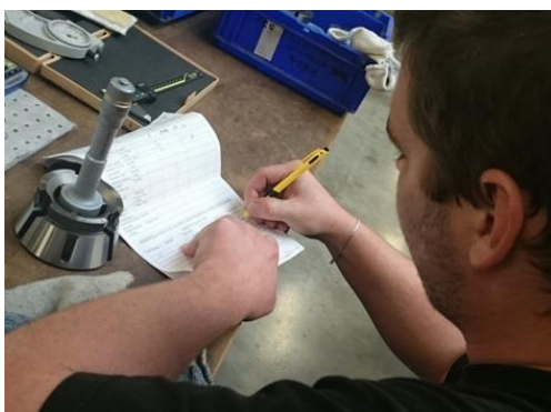
Obrázek 22 Přeměření polotovaru v procesu broušení vnitřního průměru
