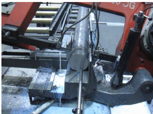
Obrázek 13 Proces řezání tyčí
