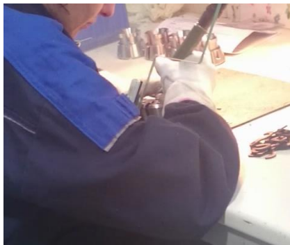
Obrázek 16 Odstranění kovových otřepů
