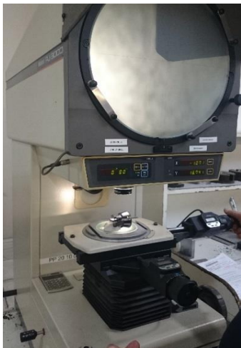
Obrázek 17 Stroj na měření rozměrů
