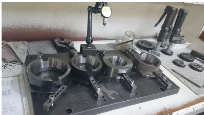
Obrázek 24 Kontrola rozměrů a házivosti
