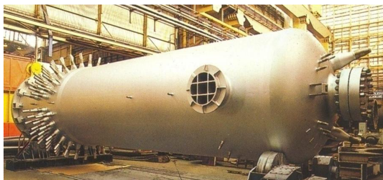
Obrázek 5 – Skutečné provedení kompenzátoru objemu [2]
