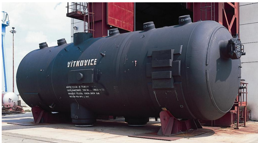
Obrázek 7 – Skutečné provedení parogenerátoru pro JE Temelín [2]
