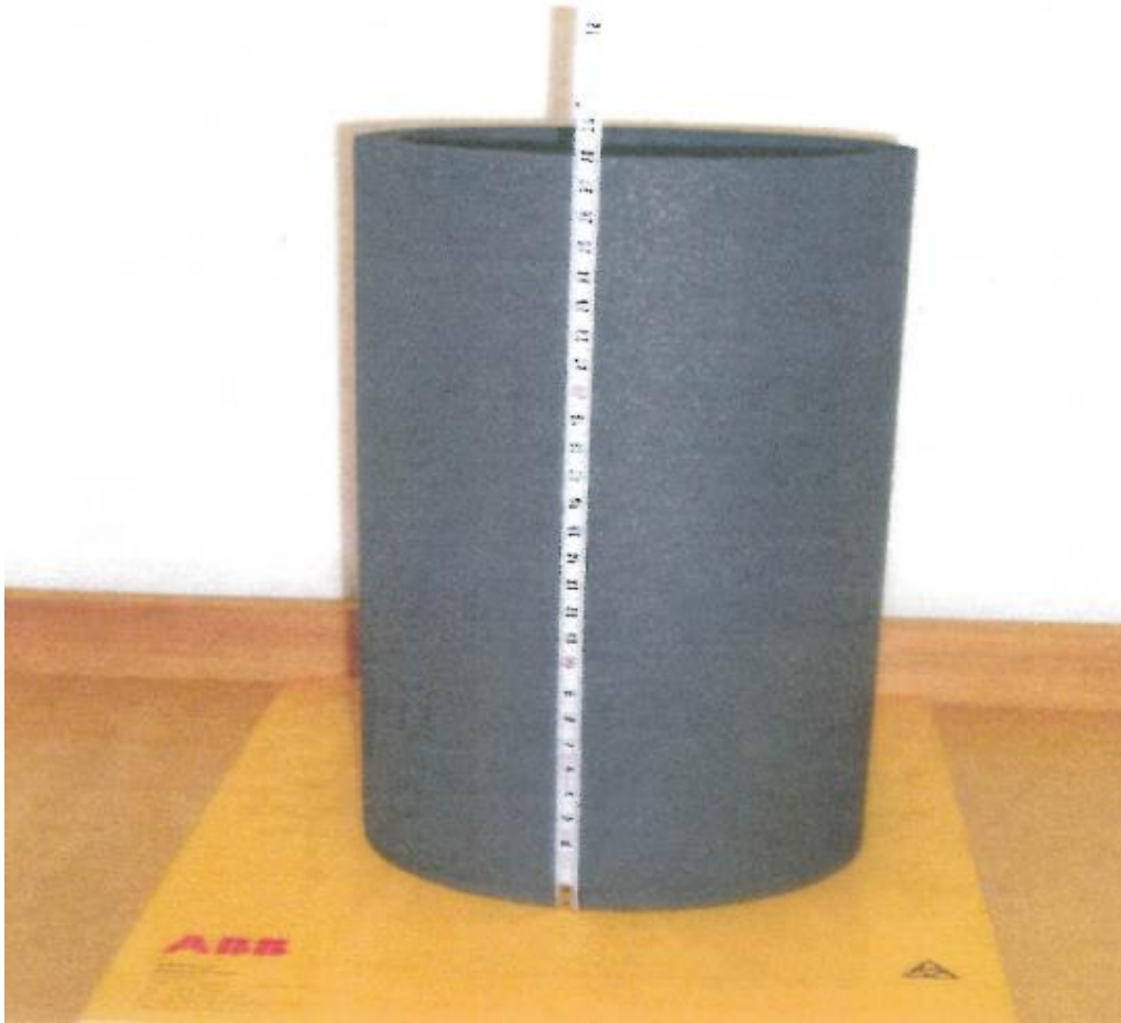
Obr. P.1.3 : Tavicí nádoba pro natavení fluoridových solí
