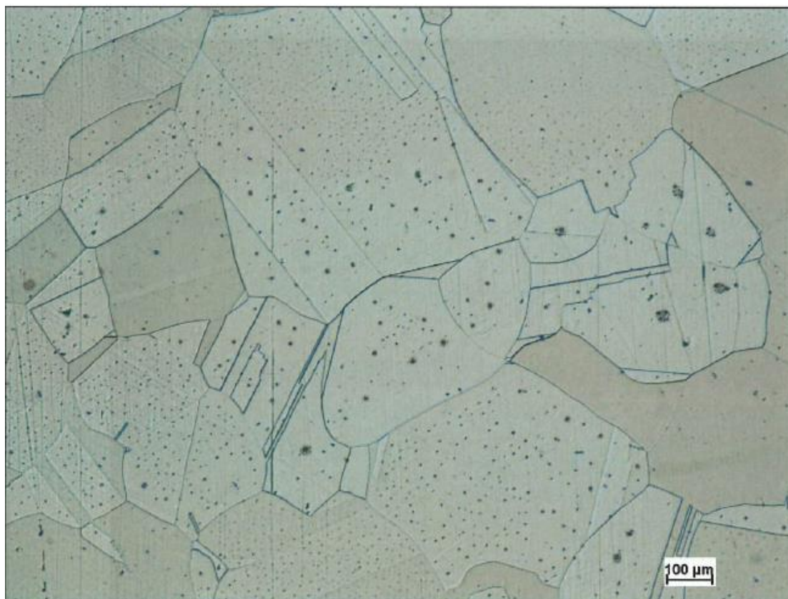
Obr. 7.3: Mikrostruktura MONICR v podélném směru – leptáno MARBLE; zvětšeno 50x [25]
