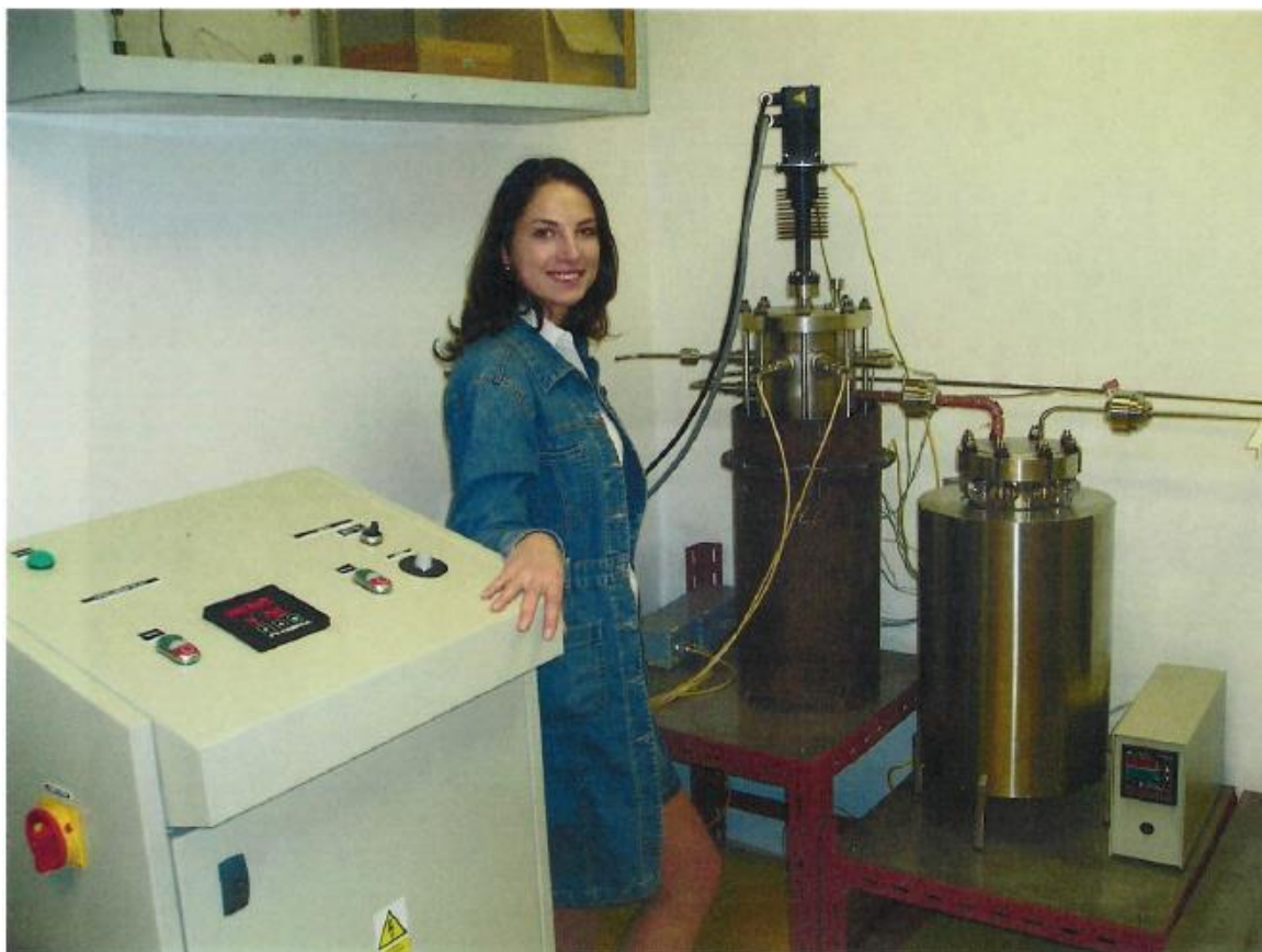
Obr. P.1.1 : První verze systému AUTOKLÁV [25]
