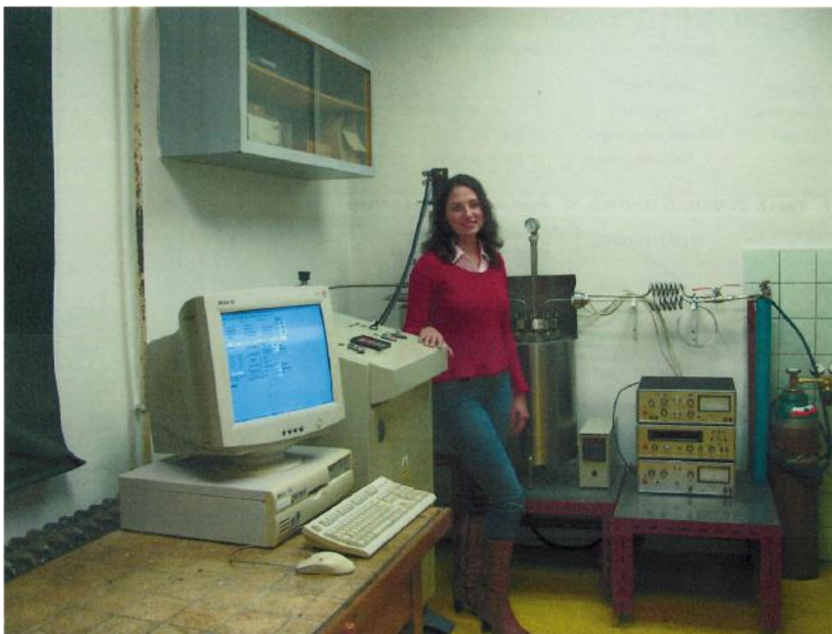
Obr. P.1.2 : Finální verze systému AUTOKLÁV ve smyčkovém uspořádání [25]
