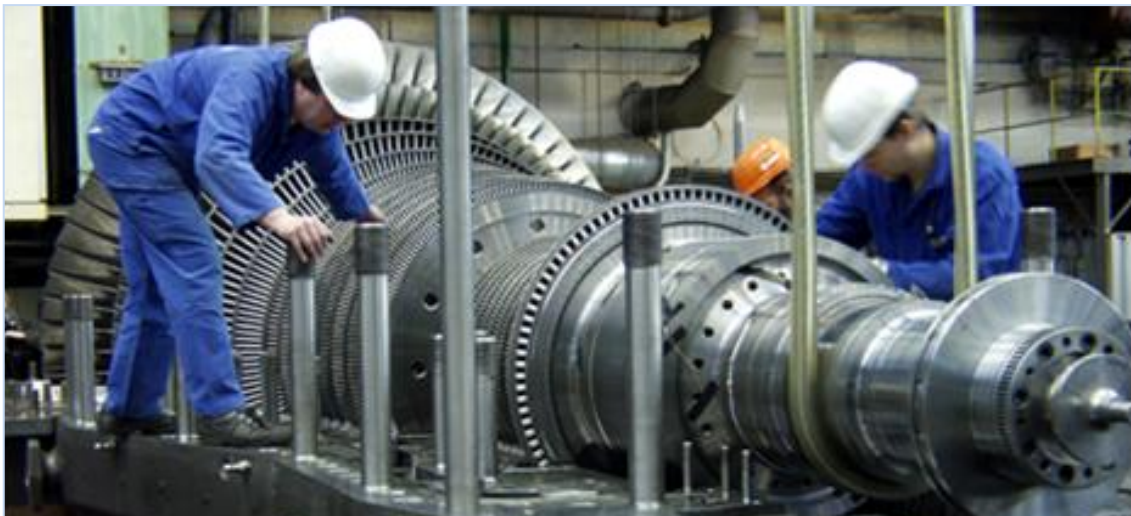
Obrázek č. 4: Montáž turbíny
