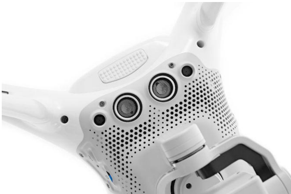
Obr. 1.8.2.6.2 Umístění ultrazvukových dálkoměrů DJI Phantom 4 [19]
