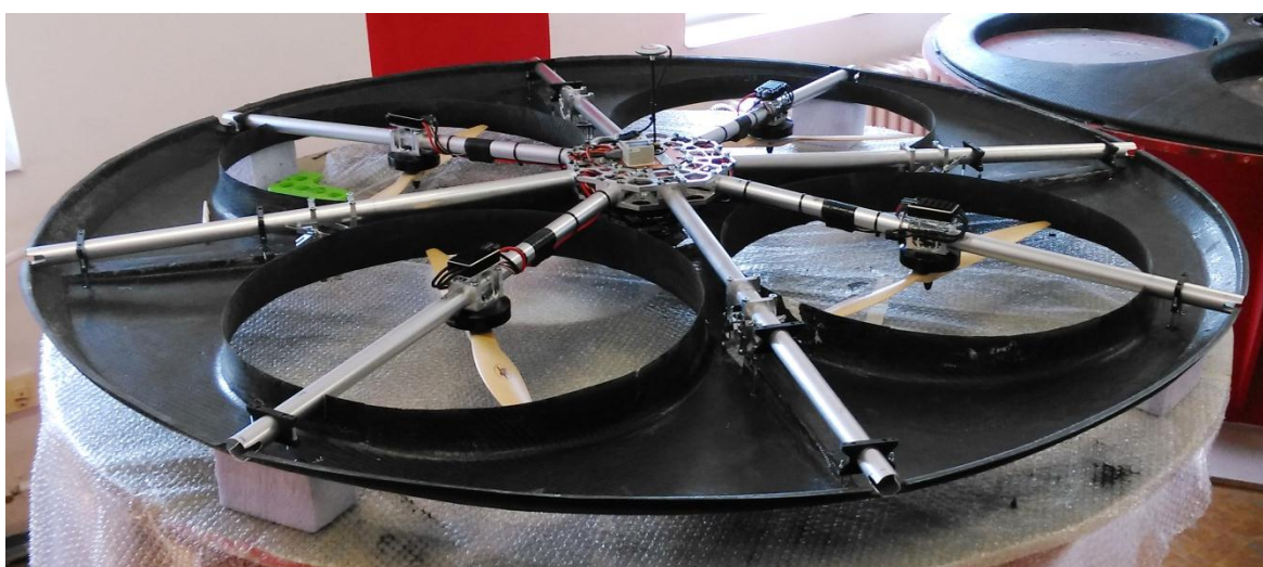
Obr. 3.4.1 Montáž spodní části krytu na nosnou konstrukci
