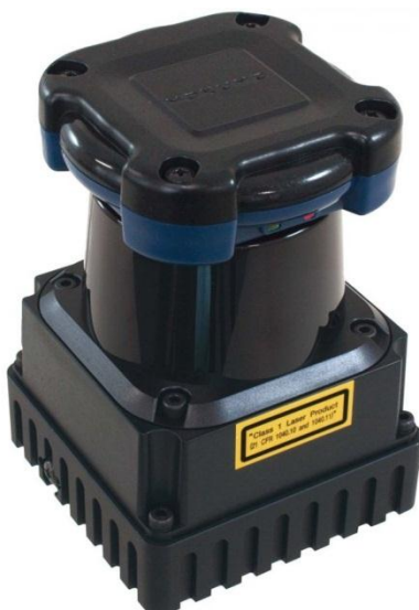
Obr. 1.8.2.7.1 Laserový skener Hokuyo UTM-30LX-EW [20]
