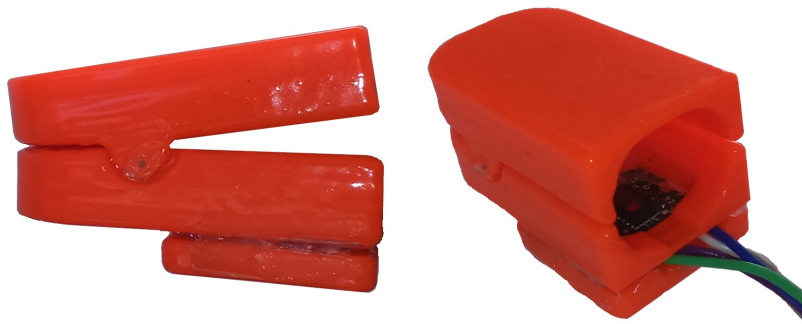
Obr. 29: Vytištěná a upravená oxymetrická sonda
