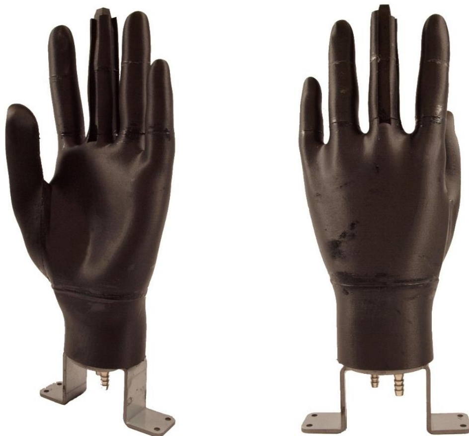
Obr. 3.1: Model lidské ruky vyrobený pomocí 3D tisku
