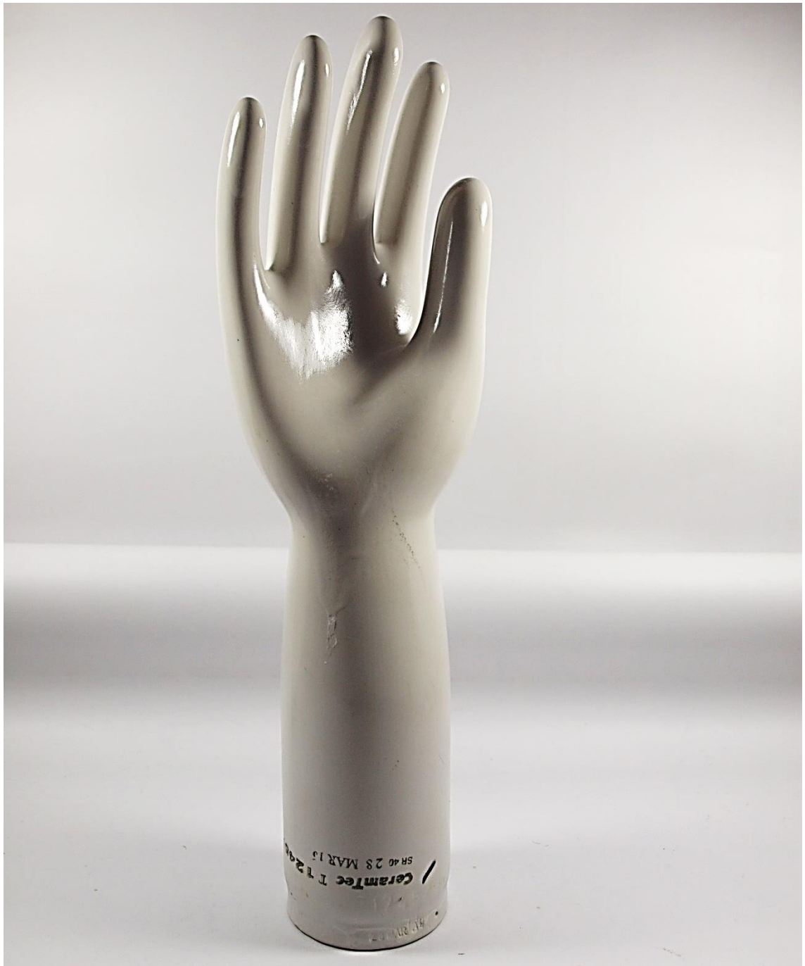
Obr. B.1: Keramický model ruky pro výrobu gumových rukavic
