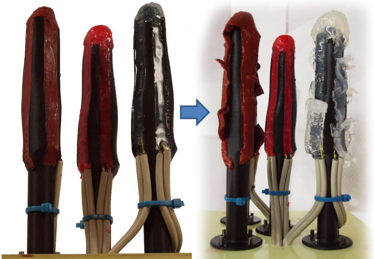
Obr. 4.6: Degradace silikonových zalévacích hmot po cyklickém měření v termostatické olejové lázni
