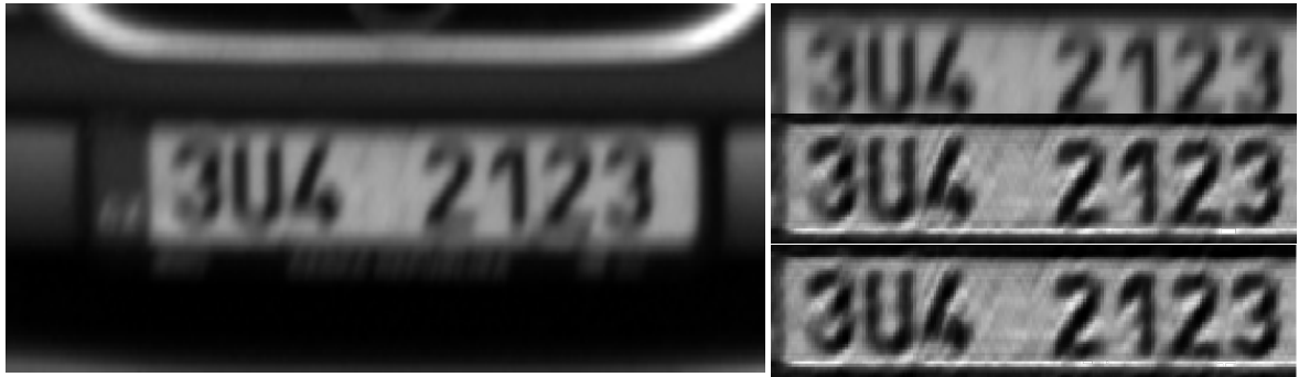
Obr. 7.2 - 2. Ukázka použití algoritmu Deconvolution , odhad PSF – „motion, Len = 10, Theta 90“, (vlevo) – původní obrázek, (vpravo, shora) – lokální část, blind deconvolution s 15 iteracemi, Lucy-Richardson s 15 iteracemi
