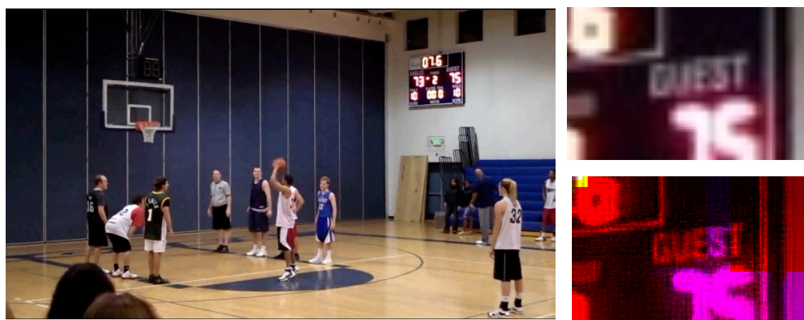
Obr. 7.5 – 2. ukázka použití algoritmu pro super-resolution imaging, (vlevo) – původní obraz, (vpravo, shora) – zvětšení 4x, super-resolution
