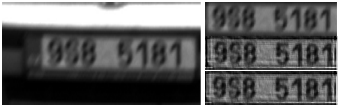
Obr. 7.3 - 3. Ukázka použití algoritmu Deconvolution , odhad PSF – „motion, Len = 10, Theta 60“, (vlevo) – původní obrázek, (vpravo, shora) – lokální část, blind deconvolution s 20 iteracemi, Lucy-Richardson s 20 iteracemi
