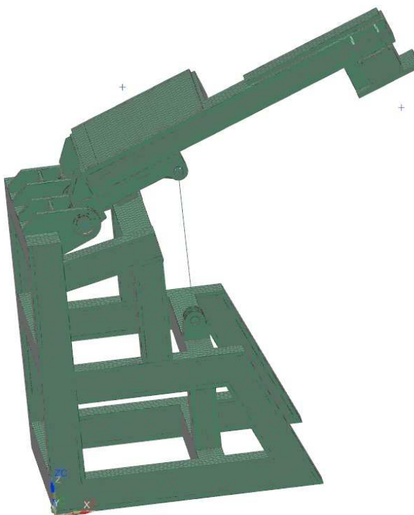
Obr. 39: Zasíťovaný výpočtový 3D model zkracovací pily
