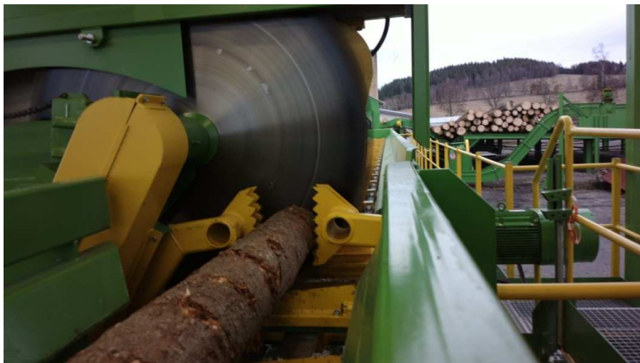
Obr. 5: Zkracovací kotoučová pila kyvná
