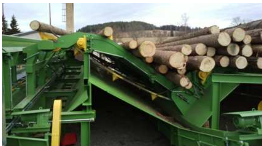
Obr. 3: Zásobní skládka se separátorem a dávkovačem
