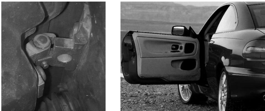
Obrázek 2.1.1 Vlevo detail závěsů na voze VW Golf III, vpravo klasicky zavěšené dveře [4]
