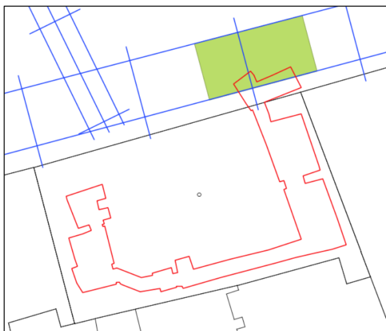
Obrázek 46: Srovnání průmětu sklepa s nalezenou anomálií – vyznačena zeleným polygonem
