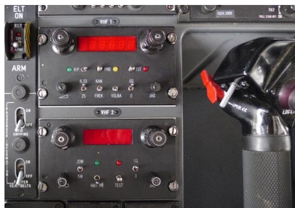
Obr. 5.2: Ovládací skříňky LUN 3520.45/3-8 v kokpitu vrtulníku
