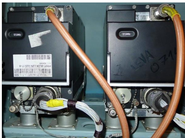
Obr. 5.3: Bloky radiostanic LUN 3520.15-8 v zadní části trupu vrtulníku
