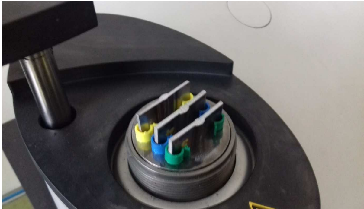
Obrázok 3.5-4 Zatavenie zvarov do vzorky.
