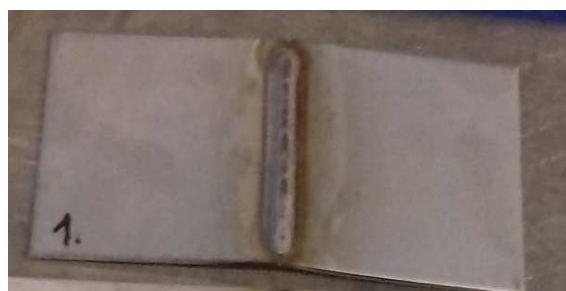
Obrázok 3.1-6 Porovnanie deformácie 1- rýchlosť zvarania v 50cm/min, 5- rýchlosť zvarania 90cm/min
