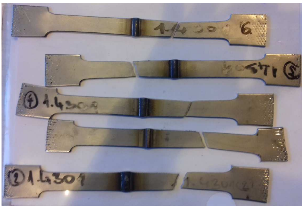
Obrázok 3.5-2 Skúšobné vzorky po pretrhnutí
