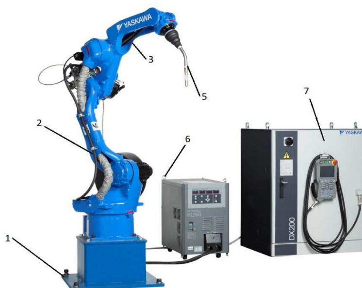
Obrázok 1.1.2-1 Hlavné časti robota
