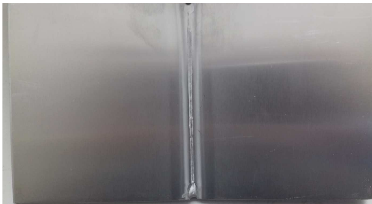
Obrázok 3.7-2 Odmorený a pasivovaný koreň zvaru
