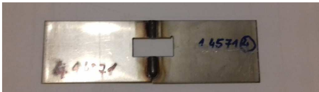
Obrázok 3.5-3 Rezanie skúšobnej vzorky pre makroskopickú kontrolu
