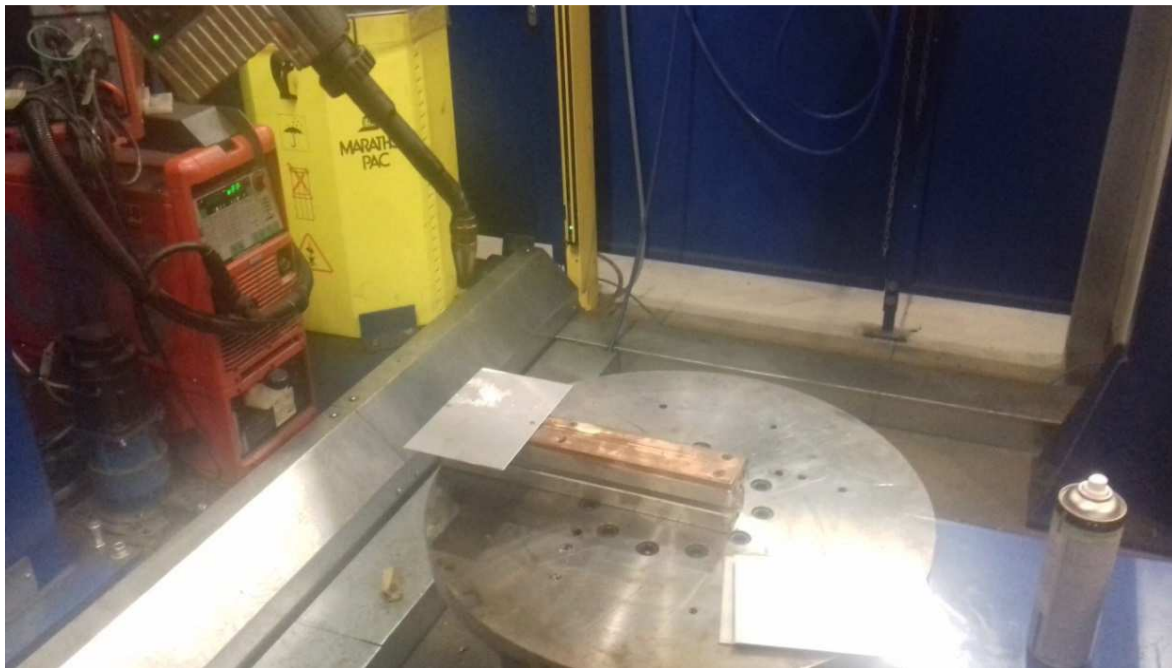
Obrázok 3.1-1 Robotizačné pracovisko príprava vzorky pred zváraním
