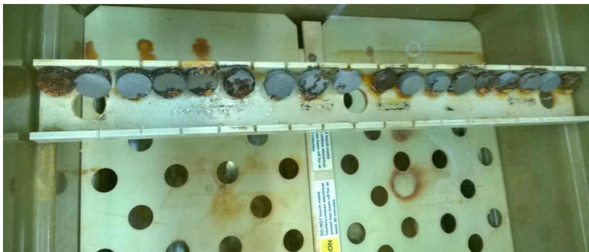
Obr. 18: Umístění vzorků v korozní komoře
