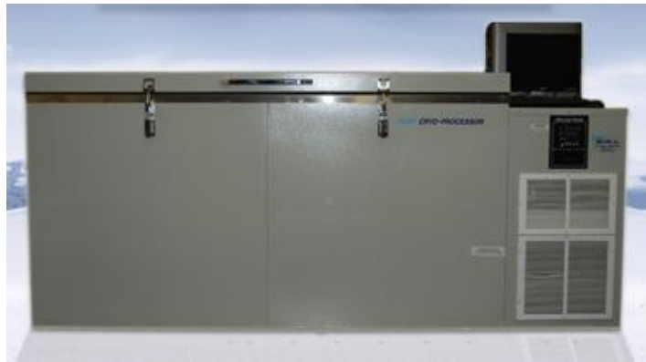
Obr. 3: Zařízení firmy 300 Below. Firma používá kaskádu kompresorů až do teploty -75^{\circ}\text{C} , následně plynný dusík. Izolace je provedena polyuretanovou pěnou [10]
