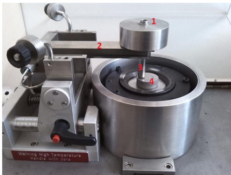
Obr. 20 Zařízení pro měření metodou PIN on DISC
