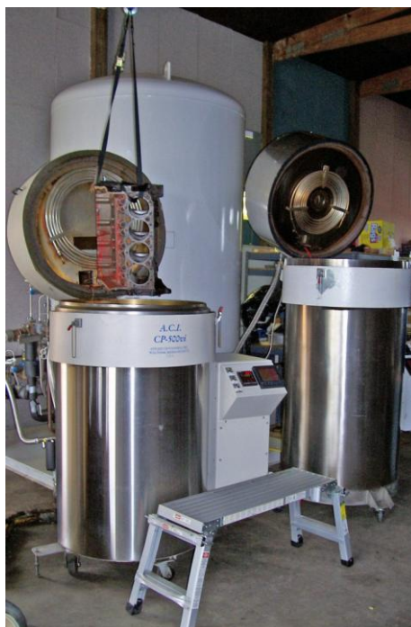
Obr. 5: Zařízení firmy Applied Cryogenics využívající vakuové izolace. Umožňuje následné popouštění do 250^{\circ}\text{C} . Spotřeba cca 7\text{LN}_2/\text{hod} . [11]
