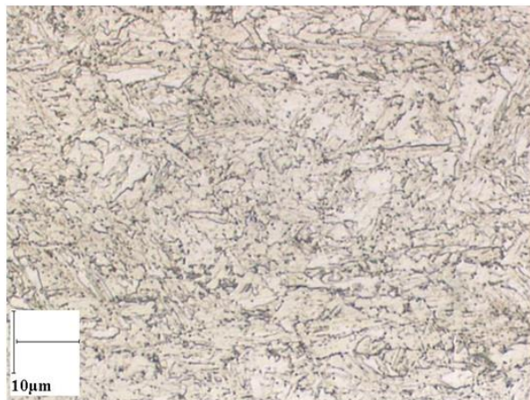
obr. 11 Mikrostruktura oceli s komplexními fázemi [2]
