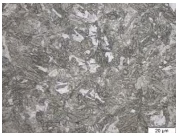
obr. 13 Mikrostruktura martenzitické oceli [2]
