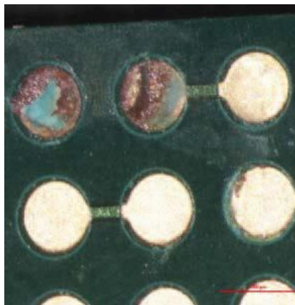
Obr. 2 Vzorek s měděnými podložkami po 48 hodinách testování [7].
