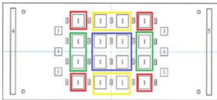
Obr. 6 Rozmístění BGA na PCB [8].
