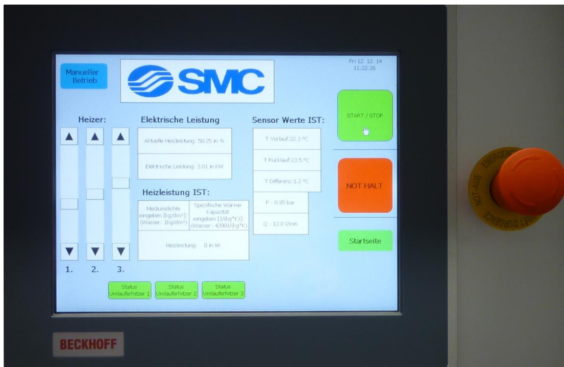
Obr. 17 - Detail ovládacího dotekového panelu zařízení umělého tepelného zatížení
