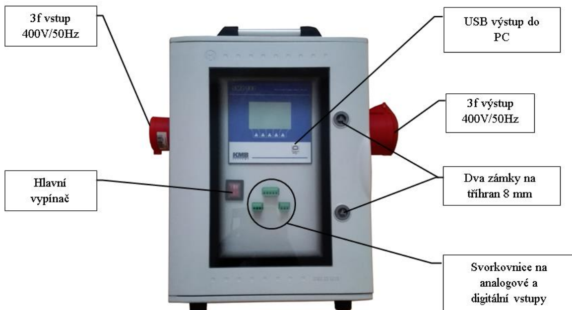
Obr. 14- Popis měřicí stanice zvenku
