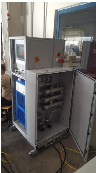
Obr. 16 – Zařízení pracující jako umělá tepelná zátěž
