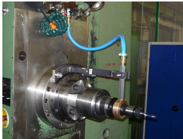
Obrázek 22: Vřeteno horizontální vyvrtávačky s vnitřním chlazením [1]
