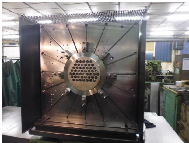
Obrázek 23: Ukázka upnutí trubkovnice na horizontální vyvrtávače (1)
