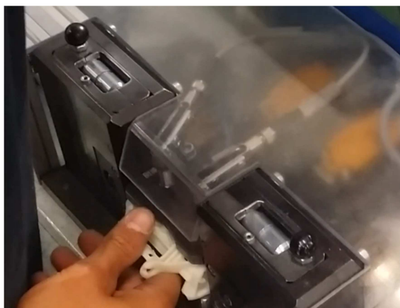
Obrázek 36 - Lisování závaží - ST 10
