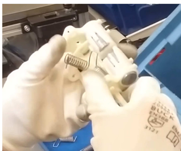
Obrázek 38 - Montáž dvojité pružiny a osičky - ST 20
