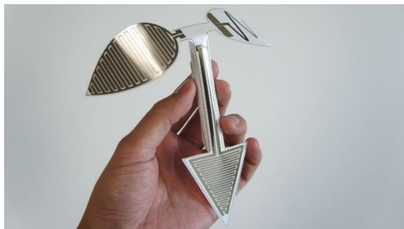
Obr. 3.2 Sada tištěných RH senzorů s RFID anténou Sensprout (převzato z [30])
