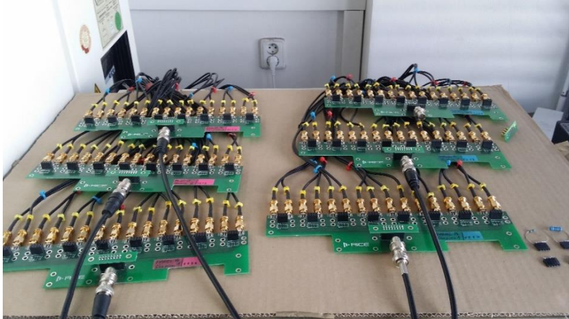
Obr. 5.5 Přípravky používané pro propojení senzorů s generátory signálů a měřícím můstkem
