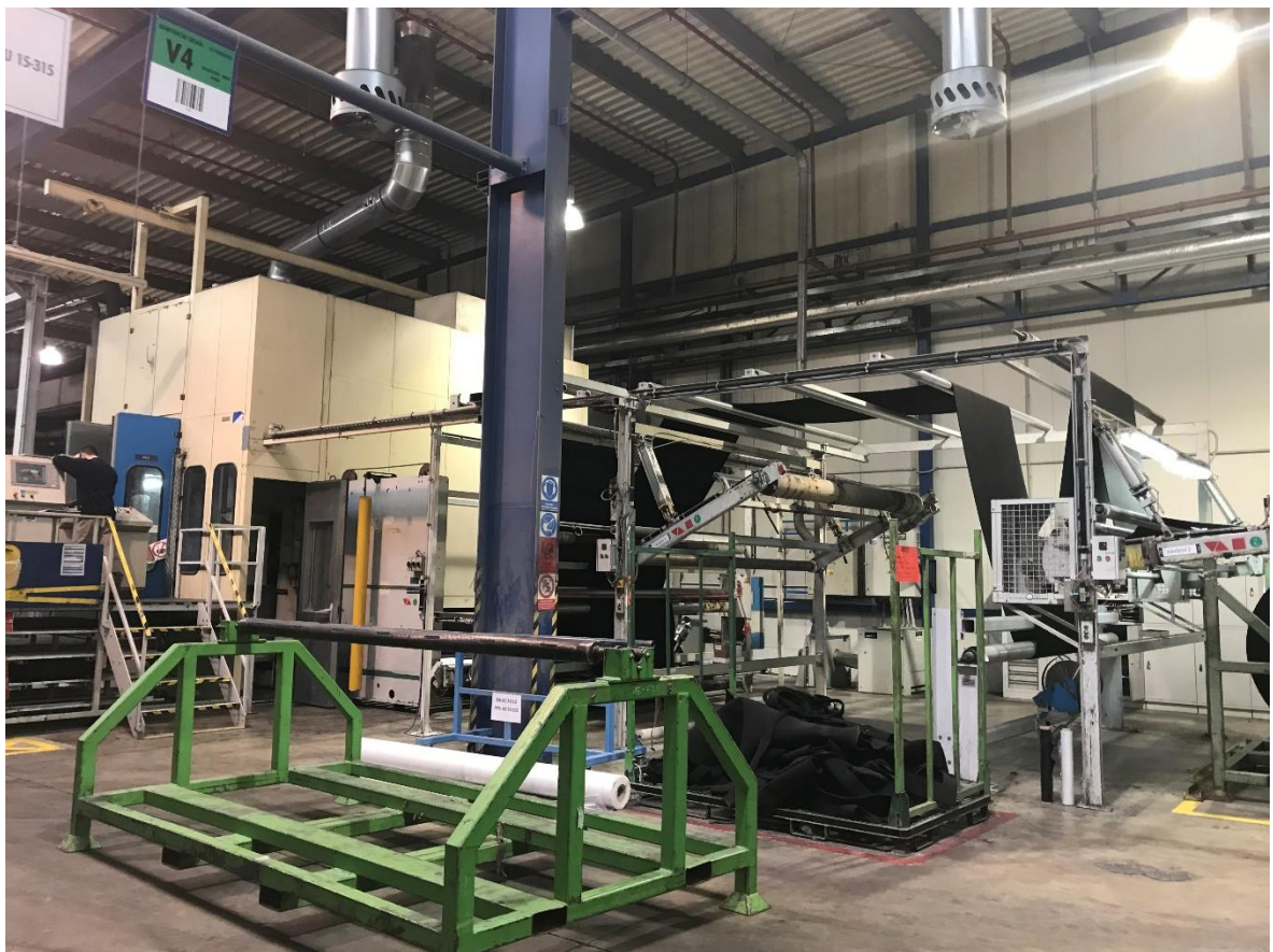
Obrázek č. 20 : Šicí zařízení na lince 15-315 a zakončení linky
