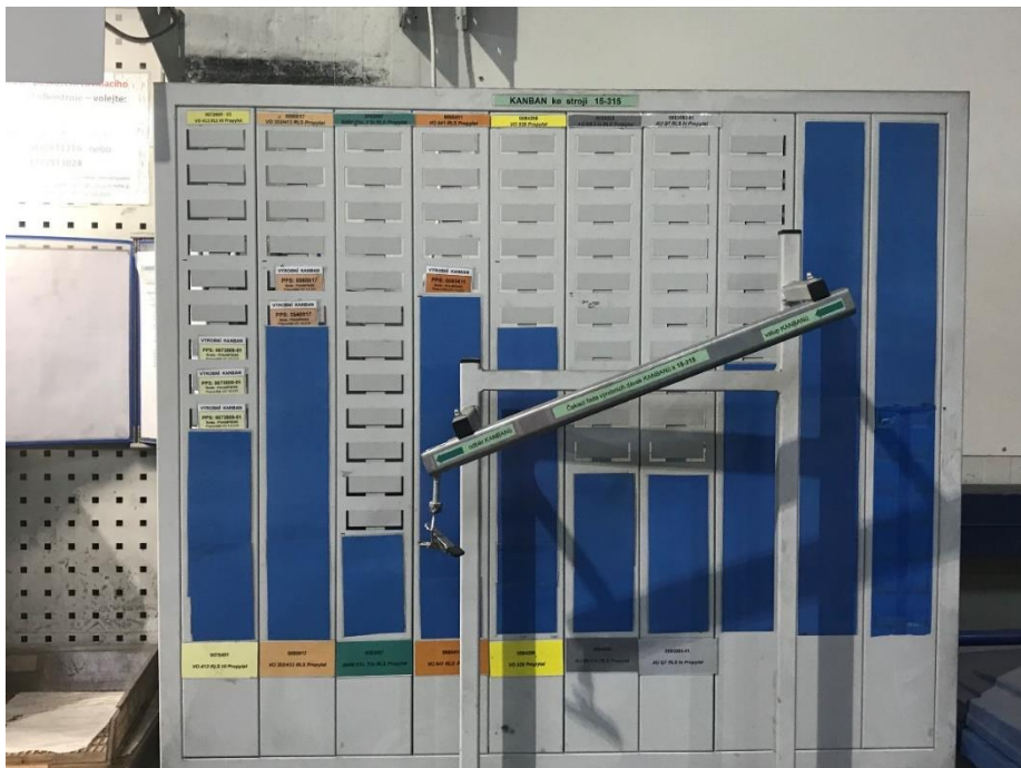
Obrázek č. 15 : Kanbanová tabule s čekací řadou na pracovišti 15-315
