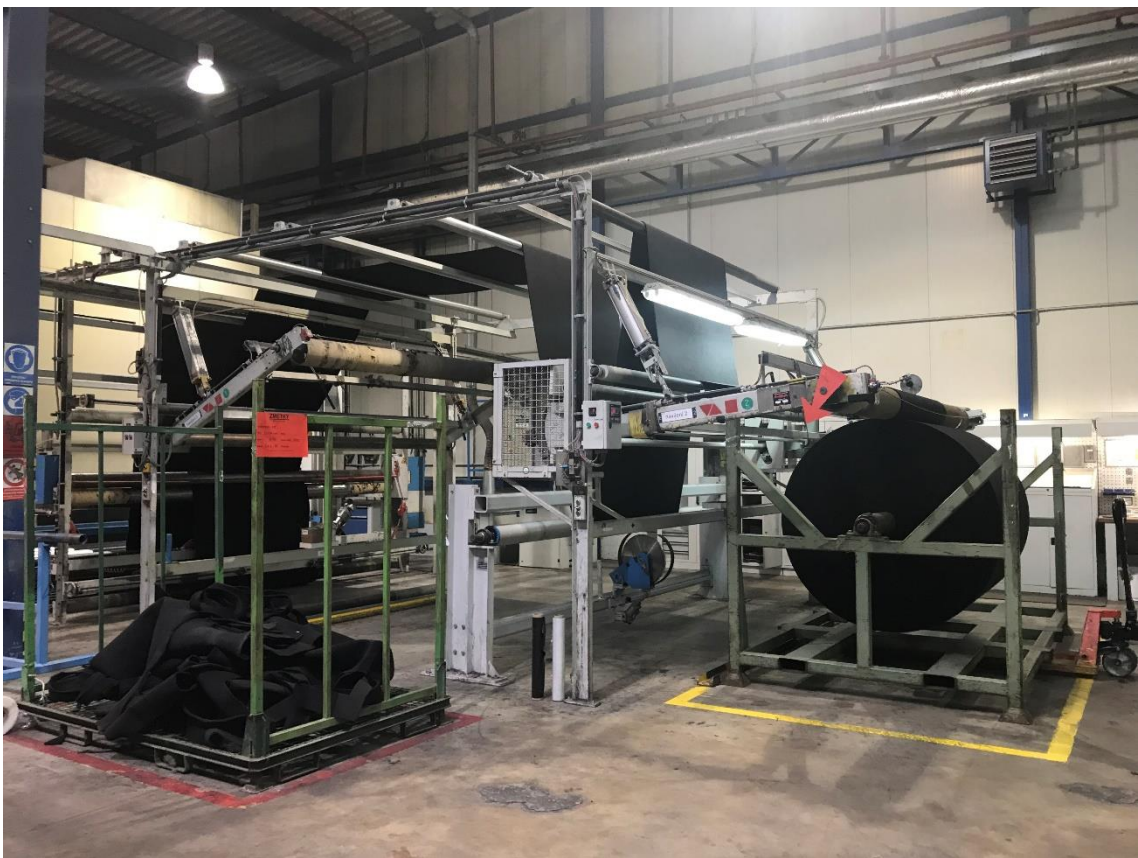
Obrázek č. 21 : Navijení hotového propylátu na lince 15-315
