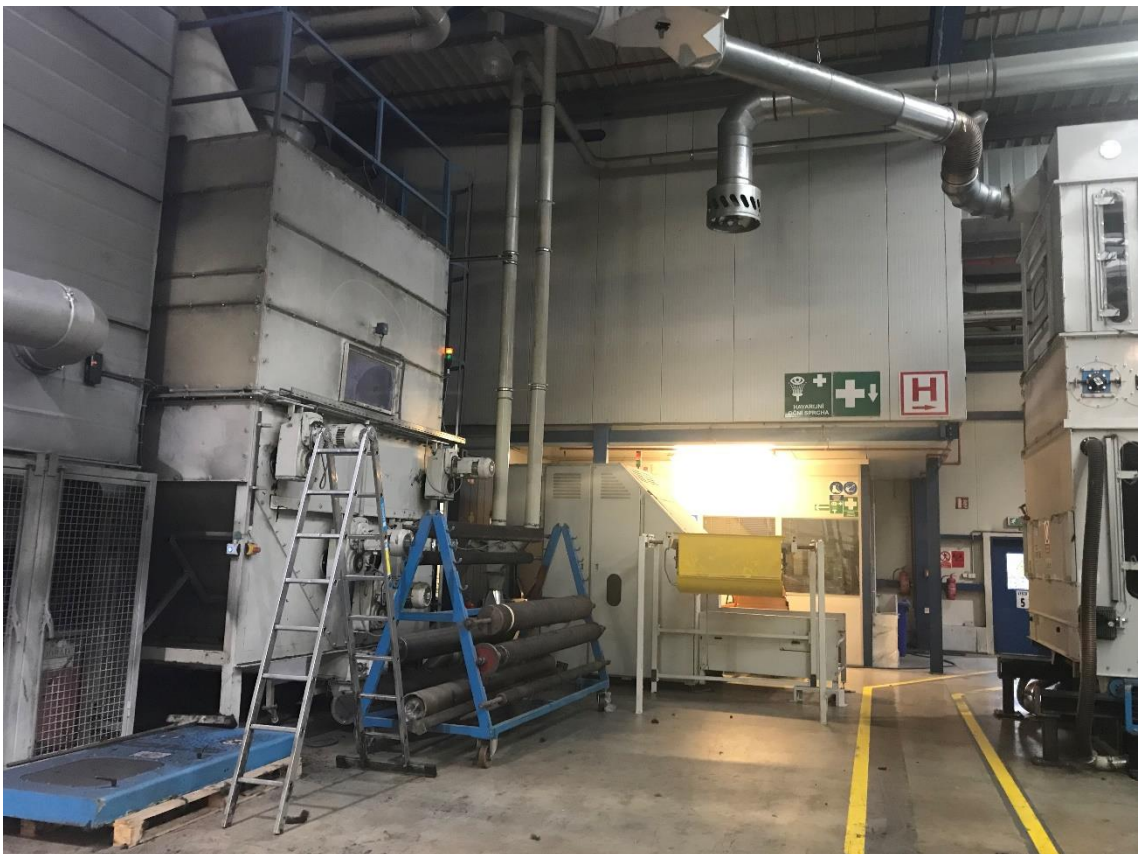
Obrázek č. 18 : Mykací zařízení na k lince 15-315
