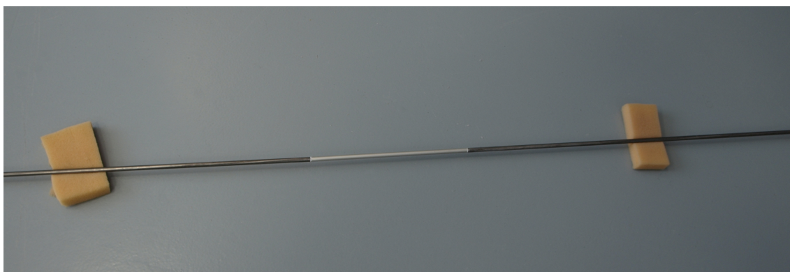
Obrázek 22: Spojení částí heterogenní tyče a její uložení při experimentu
