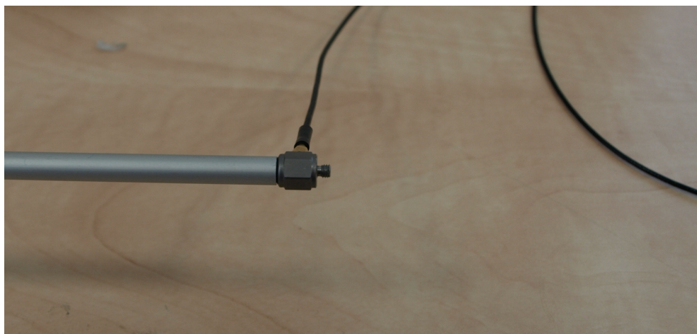
Obrázek 21: Připevnění akcelerometru k tyči
