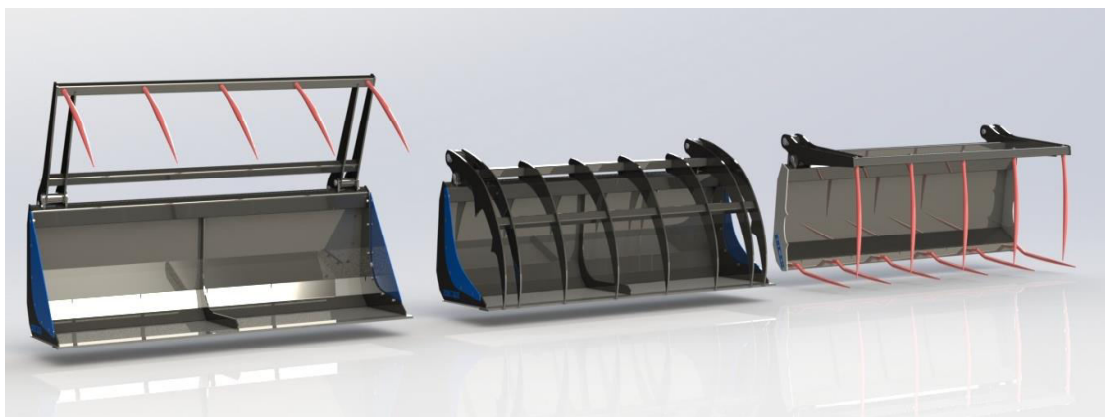
Obr. 9: Konstrukční řešení lžic, zleva nakládací s trny, s těžkým svíracím přídržovačem, s trny místo podlahy
