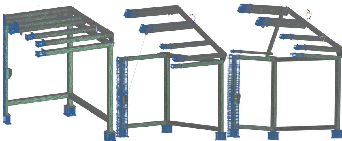
Obr. 39: Výpočtový model s okrajovými podmínkami
