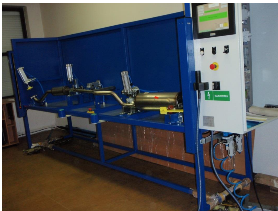
Obr. 8: Přípravek na kontrolu a osazení výfuku
