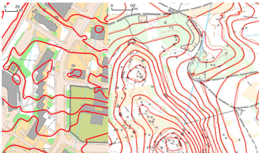
Obrázek 3: Porovnání vyhlazených vrstevnic pomocí Hermite spline interpolace (červeně) s ručně udělanou mapou pro OB v oblasti sprintové mapy s intervalem 2 m (vlevo) a v lesním prostoru s intervalem 5 m (vpravo)
