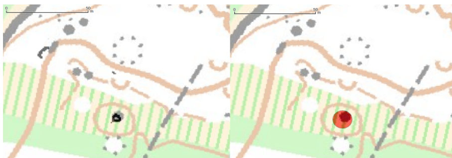
Obrázek 8: Vlevo černé polygony reprezentující místa s velkou sklonitostí, vpravo již identifikovaný balvan (červený bod), vše zobrazené nad ručně vytvořenou mapou pro OB v lesním prostoru
