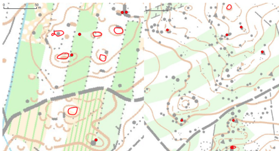
Obrázek 10: Nalezené malé kupky/balvany (červené body) a pomocné vrstevnice kupek (červené linie) nad ručně vytvořenou mapou pro OB v lesním prostoru
