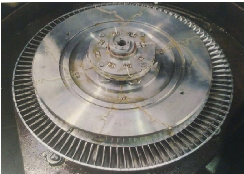
Obrázek 5.1: Olopatkovaný disk rhombických lopatek, převzato z [Kubín & Hlous (2014)].
